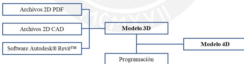
Figura 4.2. Flujo de proceso para la creación de un modelo 4D (Adaptado de Khawaja y Schmeits [117])
