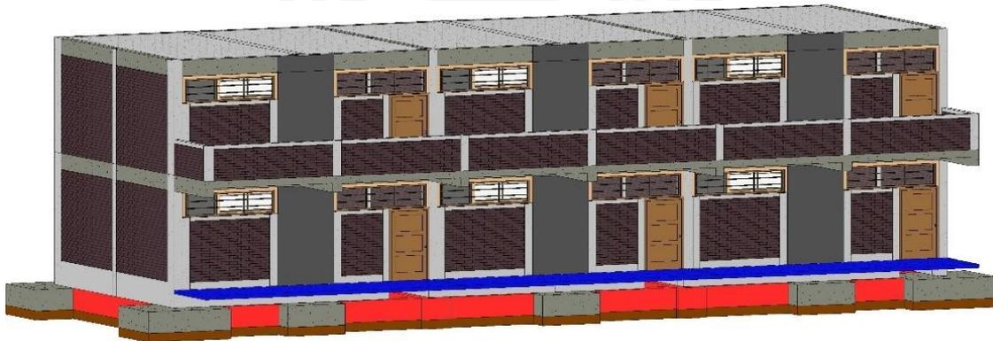
Figura 5.4. Modelo 3D de la técnica de reforzamiento sísmico MARM (Autodesk® Revit™)
