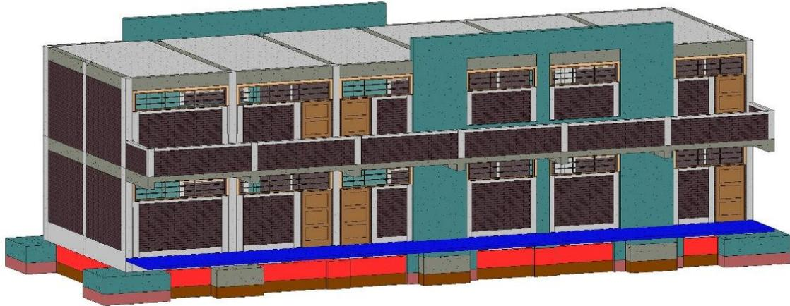
Figura 5.6. Modelo 3D de la técnica de reforzamiento sísmico IMACA (Autodesk® Revit™)
