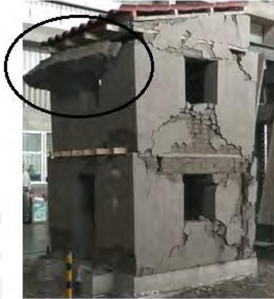
*Figure 4.38 Modelo de vivienda sin refuerzo durante el ensayo con amplitud de 90mm (a)*
