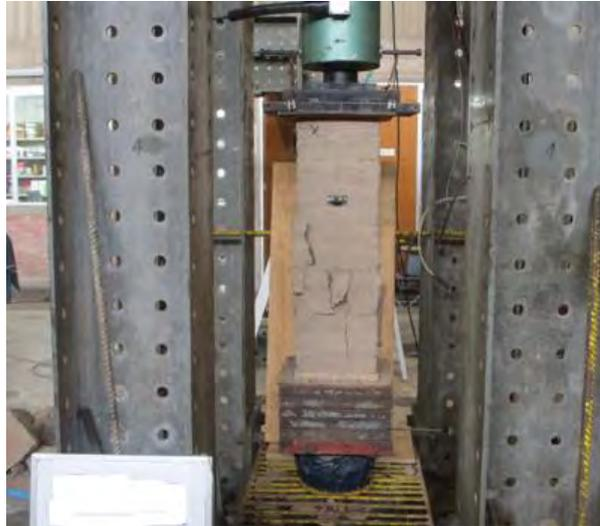
Figure 4.13 Ensayo de compresión en pilas a la mampostería de adobe
