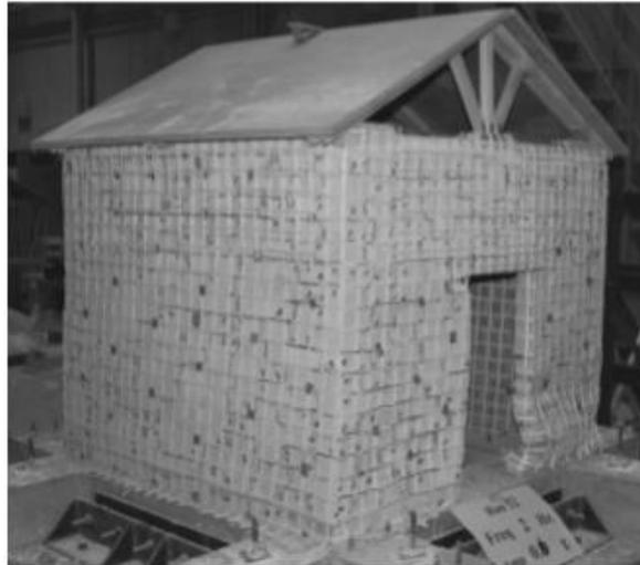
*Figura 2.19 Modelo de vivienda de adobe reforzado con bandas de polipropileno luego de ser ensayado. (Sathiparan, Mayroca , & Meguro, 2010)*
