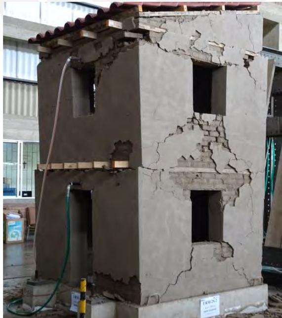
*Figure 4.37 Modelo de vivienda sin refuerzo luego del ensayo con amplitud de 60mm.*
