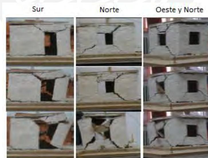
Figura 2.15 Secuencia de falla del modelo de vivienda de mampostería de adobe (Ersubasi & Korkmaz, 2010)
