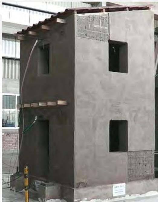
*Figure 4.43 Modelo de adobe reforzado luego del ensayo con amplitud de 15mm.*
