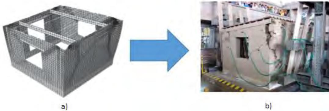
Figure 3.16 Modelo computacional (a). Ensayo de simulación sísmica (b) (Tarque, Camata, Spacone, Varum & Blondet, 2014 b).
