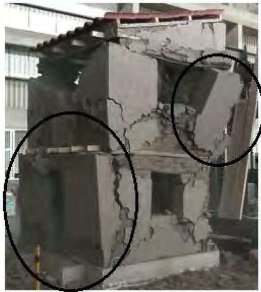
*Figure 4.40 Modelo de vivienda sin refuerzo durante el ensayo con amplitud de 90mm (c)*
