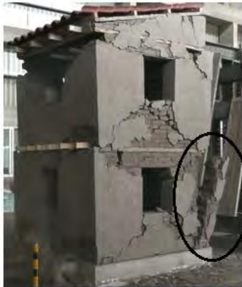
*Figure 4.39 Modelo de vivienda sin refuerzo durante el ensayo con amplitud de 90mm (b)*
