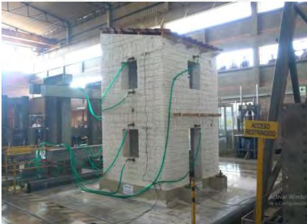
Figure 4.12. Modelo de mampostería de adobe reforzado con sogas terminado.
