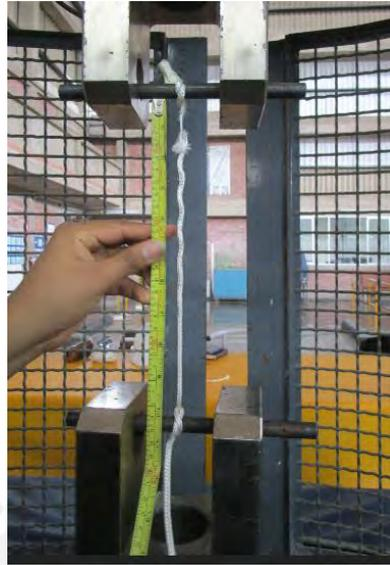
Figure 4.15 Ensayo de tracción a las sogas de refuerzo
