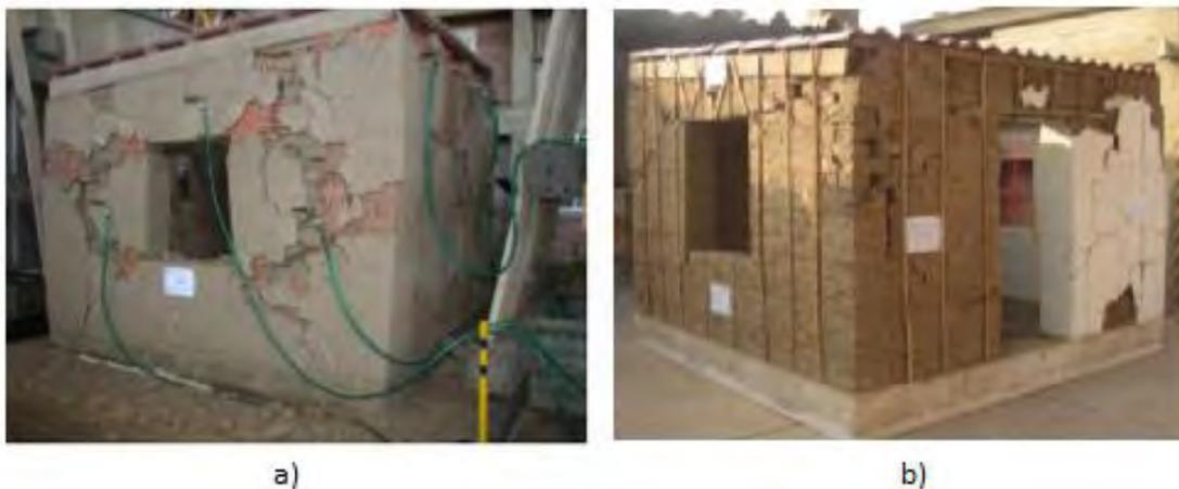
Figura 2.16 (a) Modelo reforzado con malla de plástico (Aguilar & Blondet, 2007). (b) Modelo reforzado con caña (Varum, y otros, 2014).
