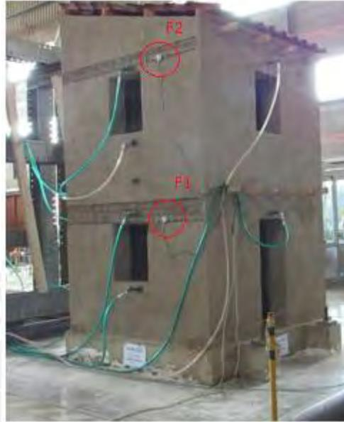
*Figure 4.29 Modelo de 2 pisos de mampostería de adobe reforzado con sogas con tarrajeo*
