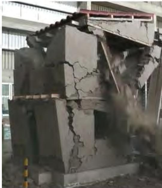
*Figure 4.41 Modelo de vivienda sin refuerzo durante el ensayo con amplitud de 90mm (d)*
