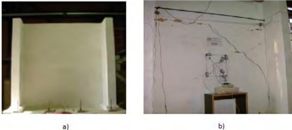
Figura 2.9 (a) Muro no reforzado antes del ensayo. (b) Muro no reforzado luego del ensayo (Figueiredo, Varum, Costa, Silveira, & Oliveira, 2012)
