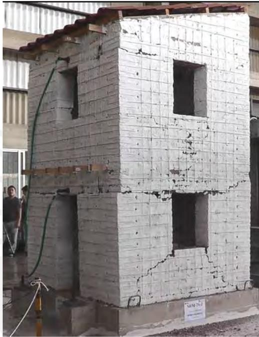
Figure 4.44 Modelo de adobe reforzado luego del ensayo con amplitud de 60mm
