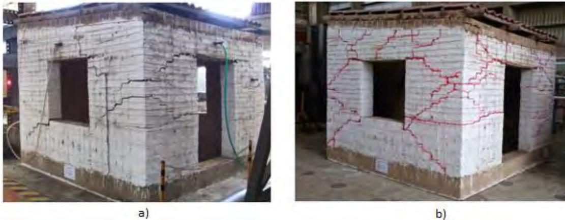
Figure 3.30 (a) Módulo reforzado durante el ensayo. (b) Módulo luego del ensayo.
