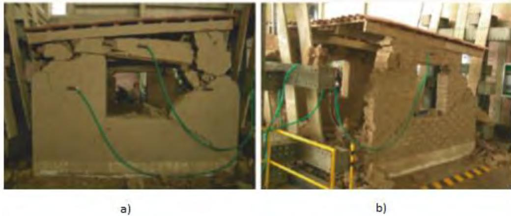
Figura 2.14 (a) Modelo de adobe en un instante del ensayo de simulación sísmica. (b) Modelo de vivienda luego del ensayo. (Tarque S., 2011)
