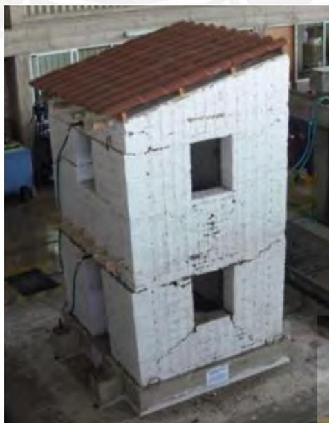
*Figure 4.30 Modelo de 2 pisos reforzado con sogas sin tarrajeo. Ensayo de 60mm*
