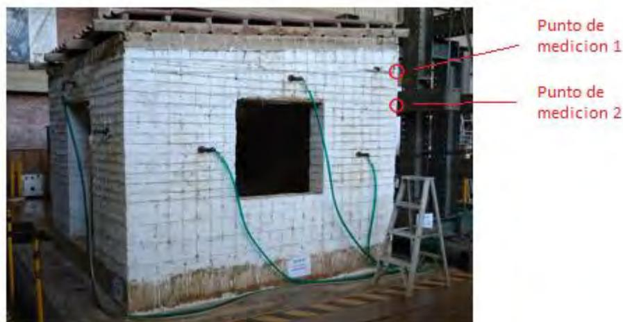
Figure 3.31 Módulo antes del ensayo con los puntos de evaluación marcados en rojo.
