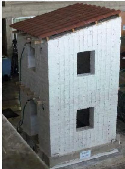
Figure 4.1 Módulo de adobe de 2 pisos reforzado con sogas reducido con una escala 1:2 sin tarrajeo colocado sobre la mesa de simulación sísmica.
