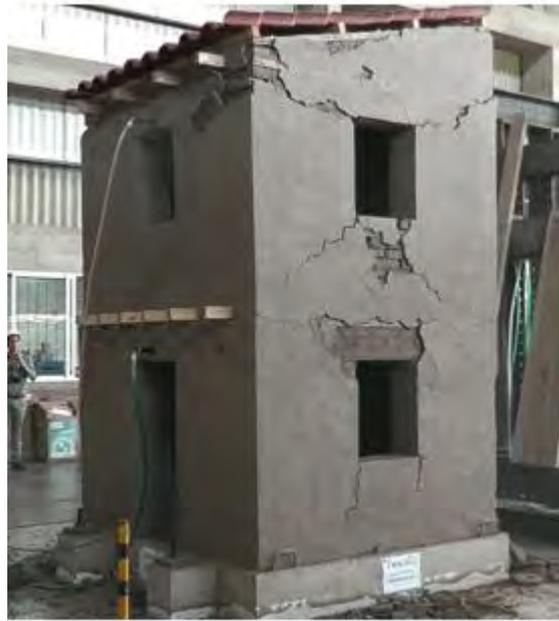
*Figure 4.36 Modelo de vivienda sin refuerzo luego del ensayo con amplitud de 40mm*
