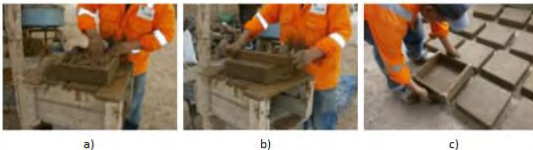
Figure 4.5. (a) Compactación del barro. (b) Nivelación con regla. (c) Desmoldamiento. (Blondet, Villa Garcia, Vargas, Sosa, & Soto, 2017)
