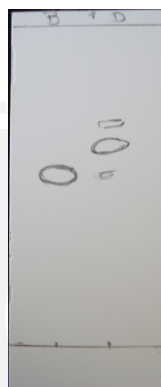
Figura 12. TLC de sílica gel en cloroformo:etanol (9:1), del BHET y del dímero.
