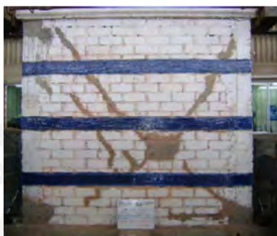
Figura 2.9: Muro de AC reforzado con CFRP, extraída de San Bartolomé y Coronel, 2009
