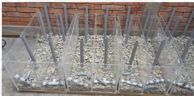
Figura 9: Distribución de piezómetros, los cuales servirán como puntos de control y fuentes de aeración
