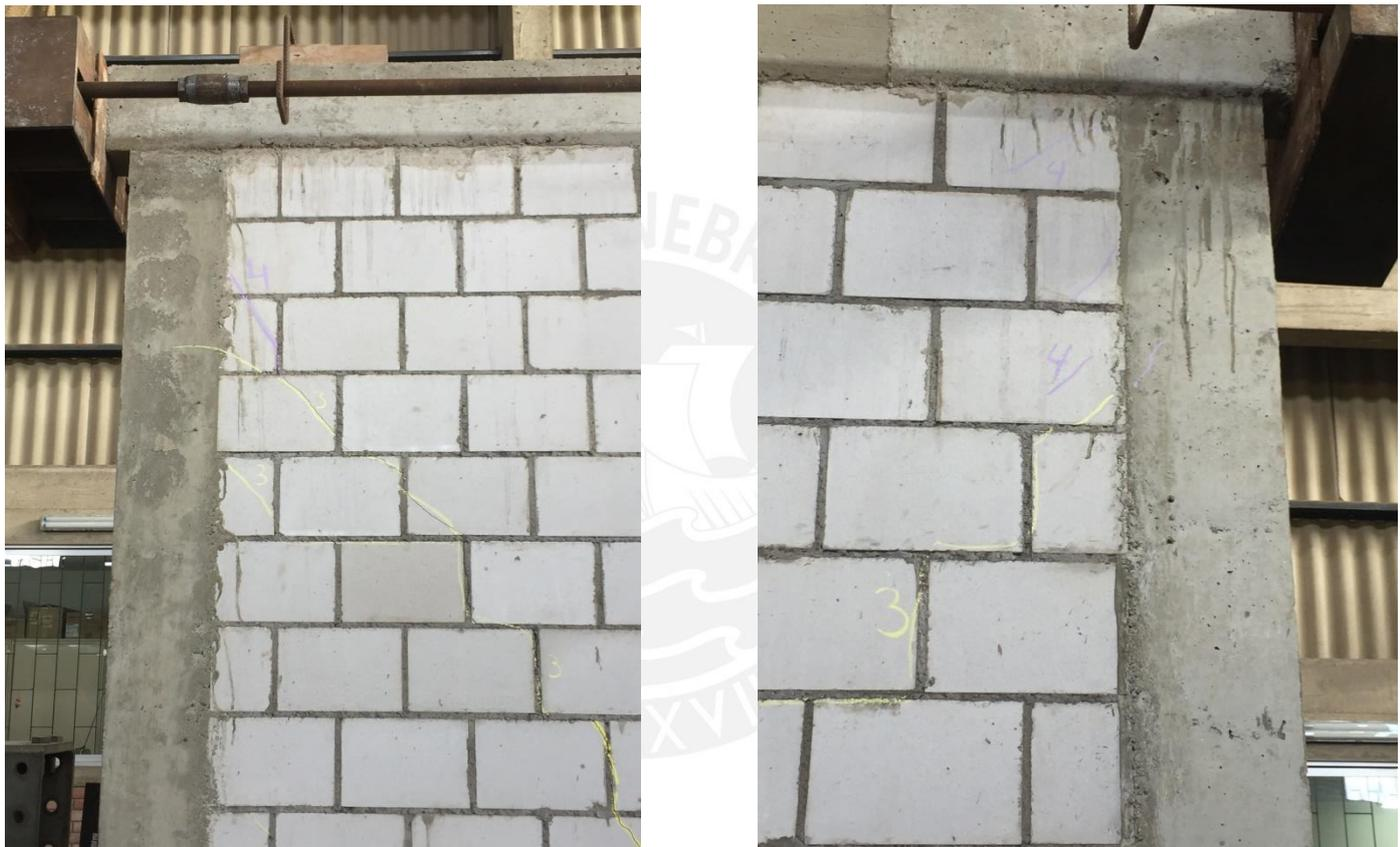
*Figura 6.7. Fisuras en muro – Fase 4*
