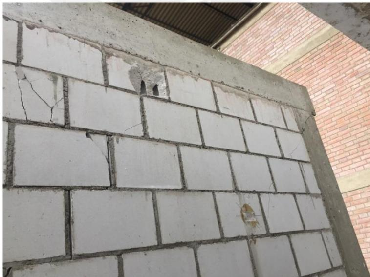
*Figura 6.16. Trituración y desprendimiento de unidades en cara posterior de muro*
