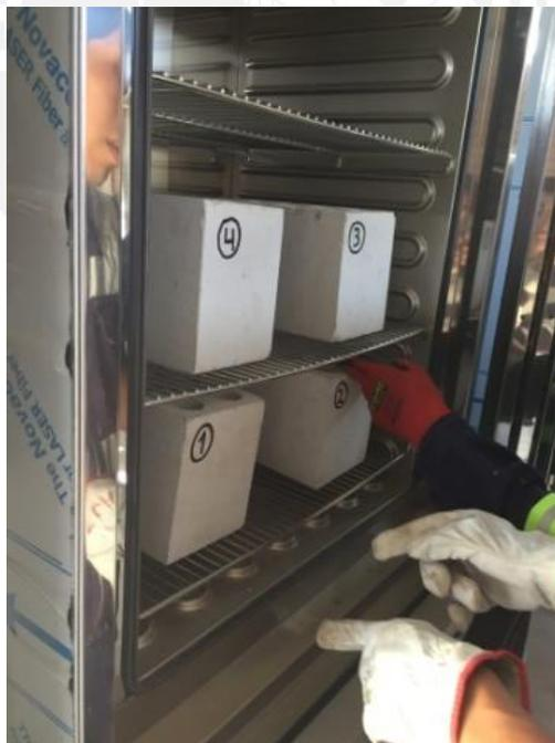
*Figura 2.7 Ladrillos secados al horno por 24 h*
