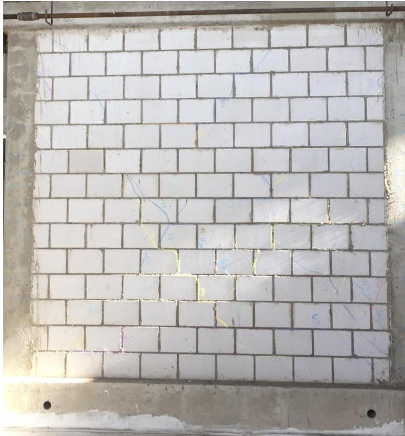
*Figura 6.10. Fisuras en muro – Fase 7*
