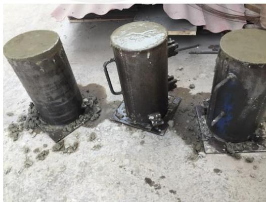
*Figura 4.5 Probetas de viga de cimentación*
