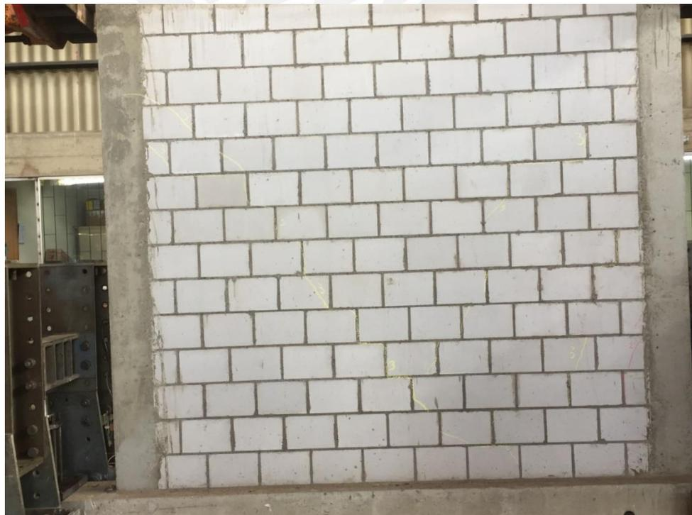
Figura 6.6. Fisuras en muro – Fase 3
