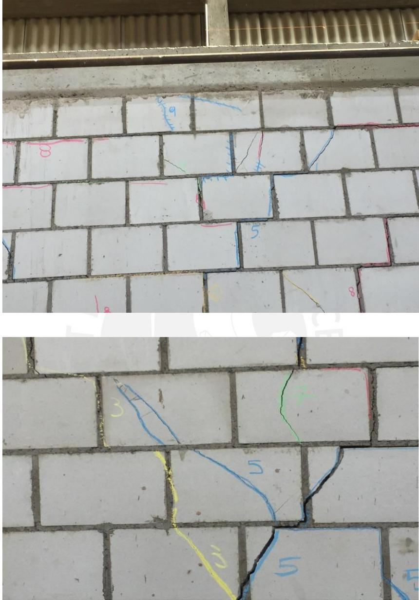
*Figura 6.12. Fisuras en muro – Fase 9*
