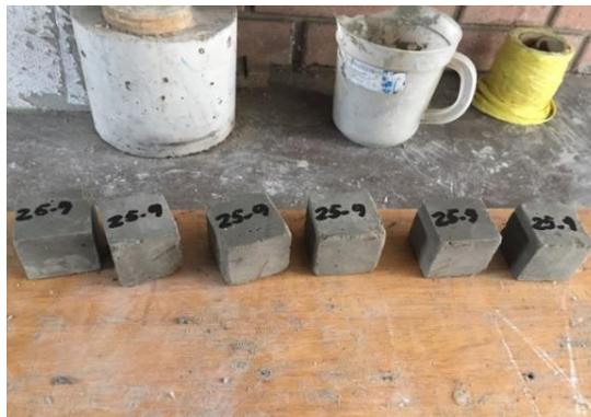
Figura 2.15 Cubos desmoldados listos para ser sumergidos durante 28 días
