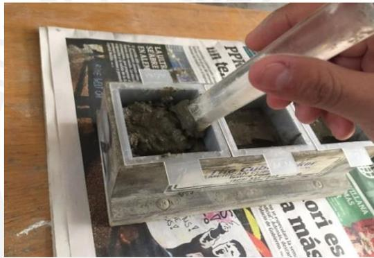
Figura 2.14 Apisonado de mortero en cada capa vaciada
