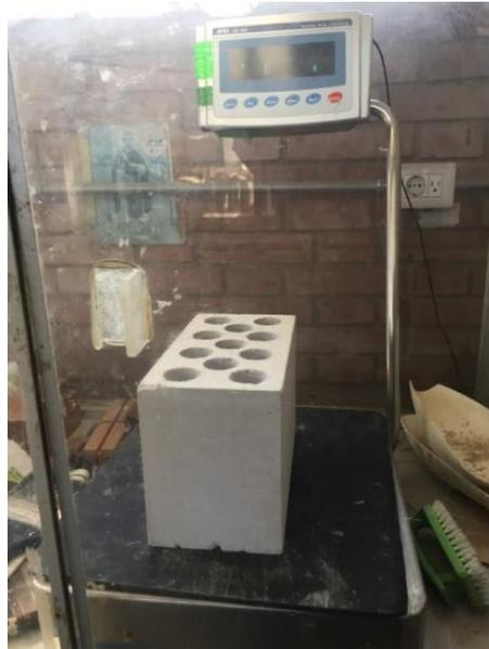
Figura 2.8 Ladrillos siendo pesados luego de permanecer 24 h en agua destilada
