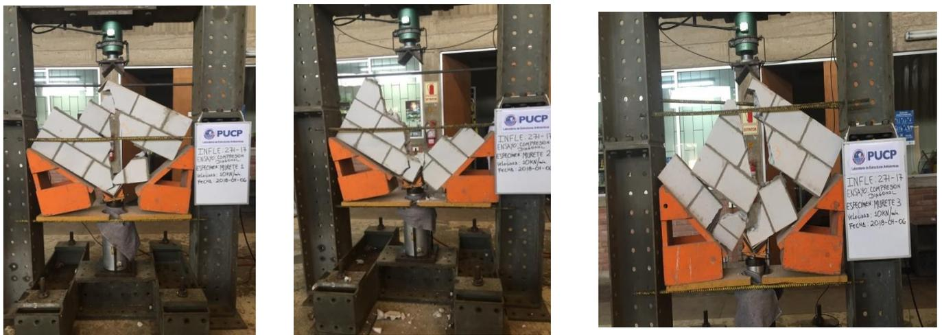
Figura 3.9 Falla típica en muretes
