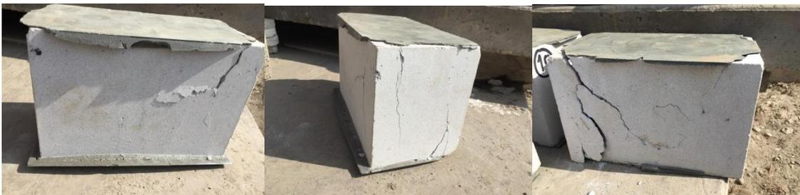
*Figura 2.6 Unidades de albañilería luego de ensayo a compresión*
