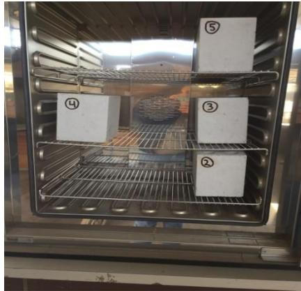
Figura 2.10 Ladrillos puestos a secar en máquina especial
