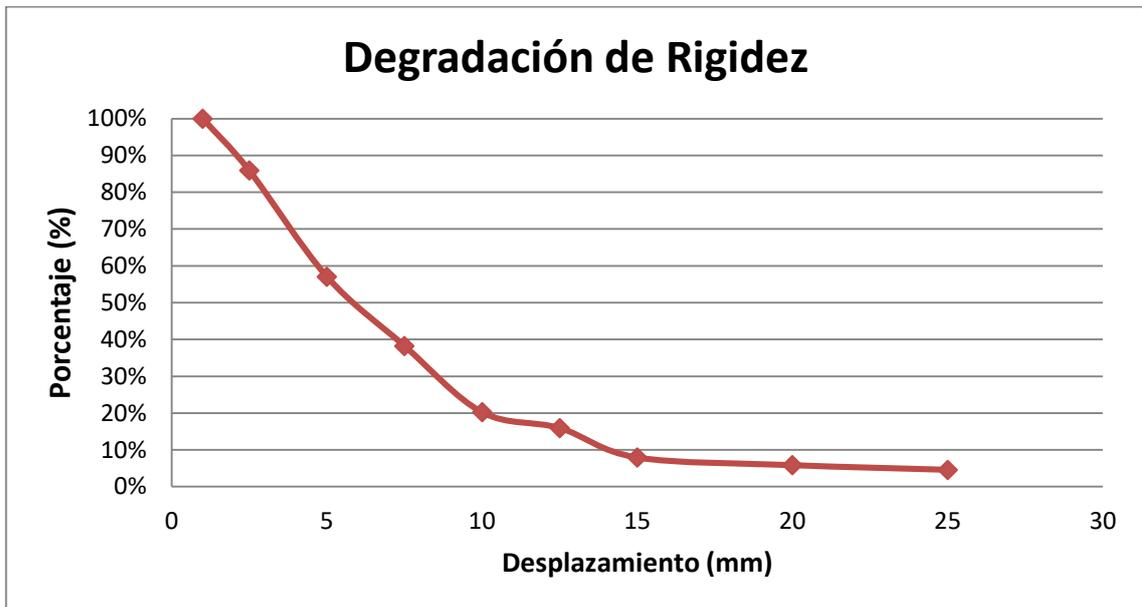
Figura 8.3 Gráfica de degradación de rigidez vs desplazamiento por fase
