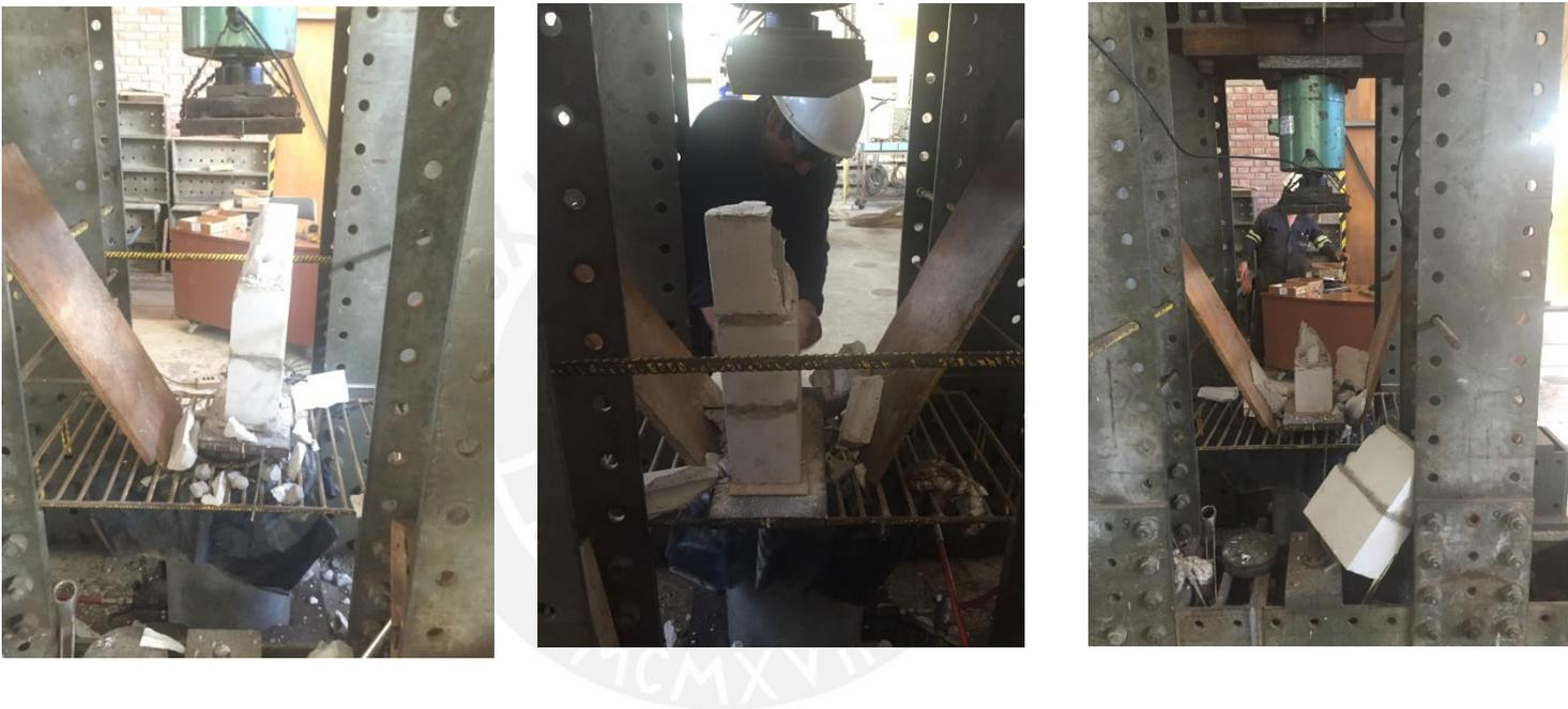
*Figura 3.4 Fallas en pilas*
