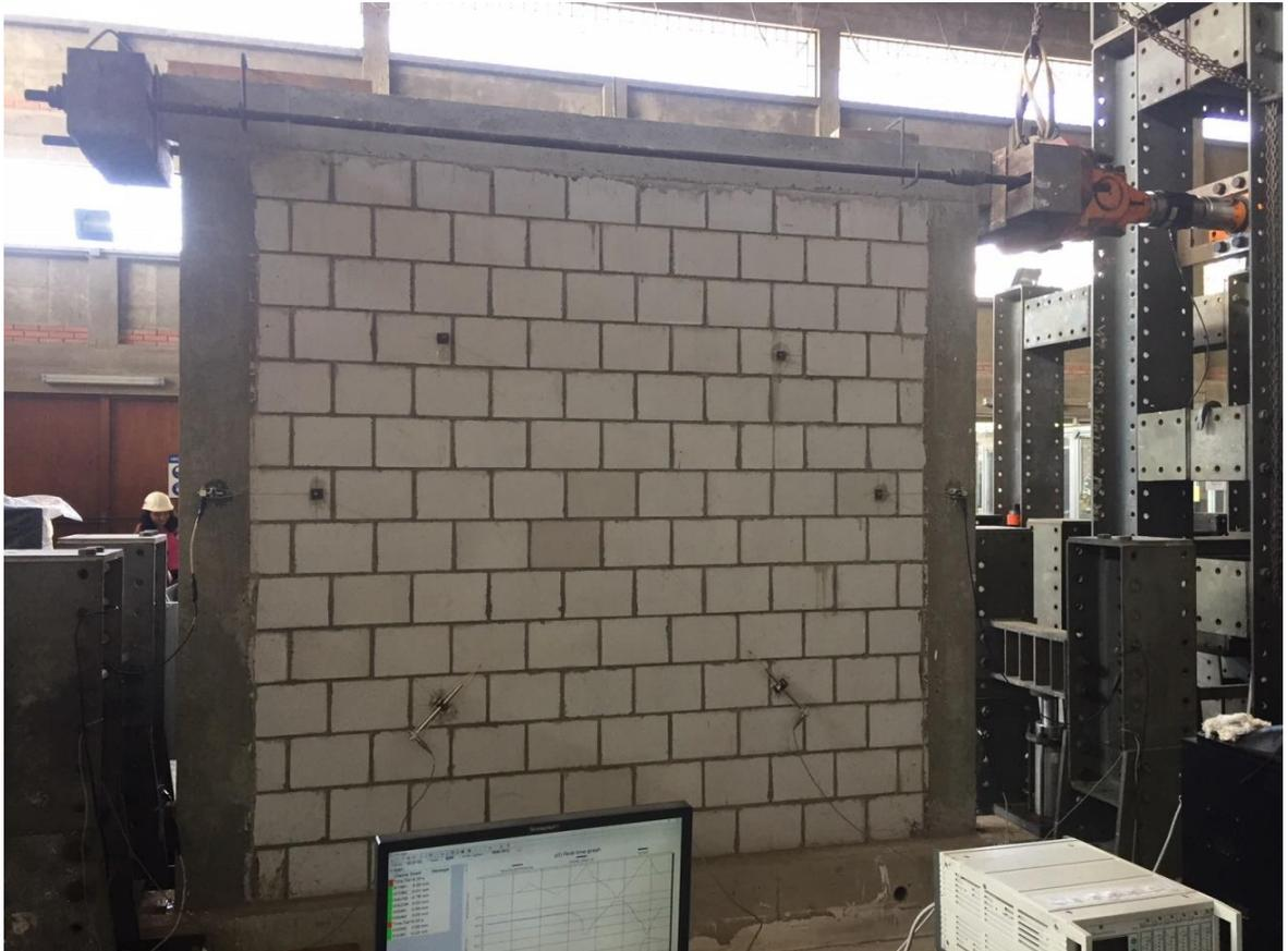
*Figura 6.2. Colocación de los LVDT*
