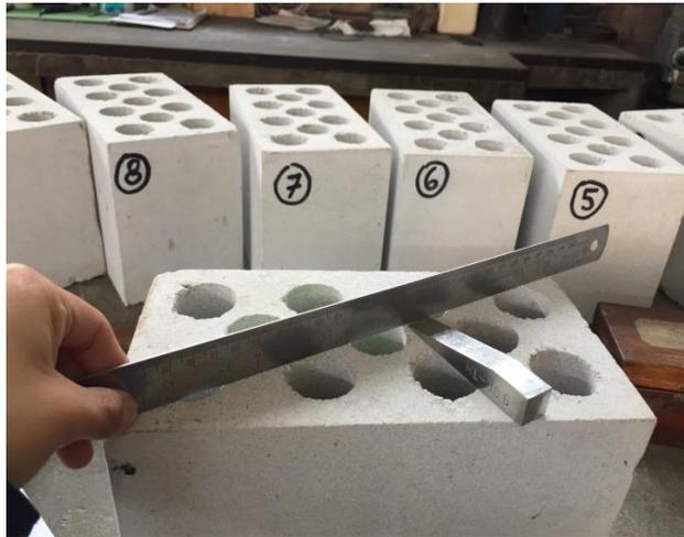
Figura 2.4 Colocación de la regla metálica y cuña para determinación del alabeo
