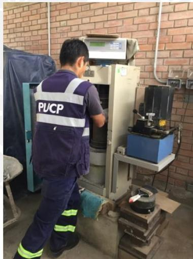
Figura 4.16. Ensayo de compresión de probetas
