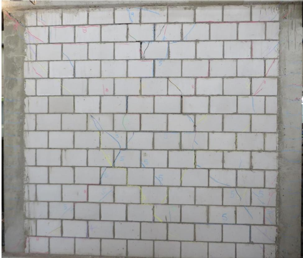
*Figura 6.13. Fisuras en muro – Armónico*
