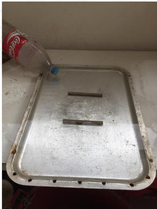
*Figura 2.9 Bandeja para ensayo de succión*
