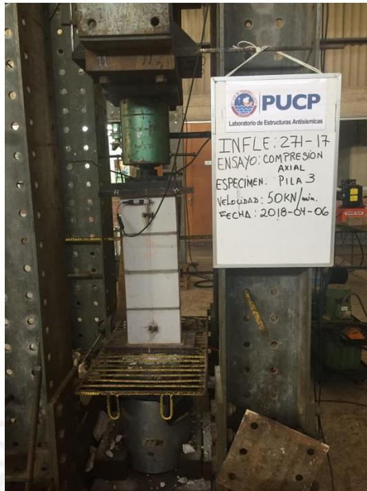
Figura 3.3 Instrumentación en pilas
