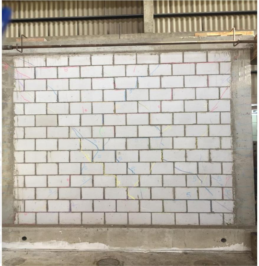
Figura 6.11. Fisuras en muro – Fase 8
