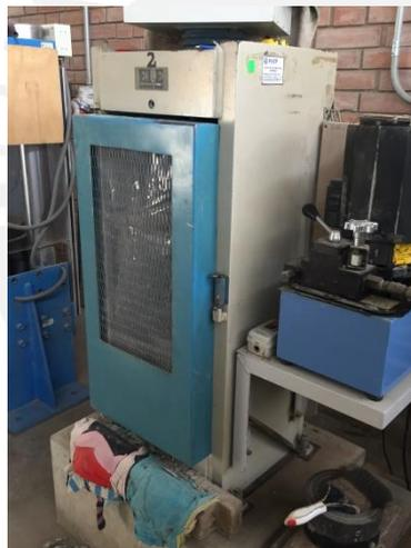
*Figura 2.5 Máquina de compresión*
