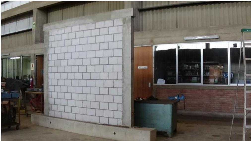
*Figura 4.17. Muro de albañilería terminado dentro del laboratorio*
