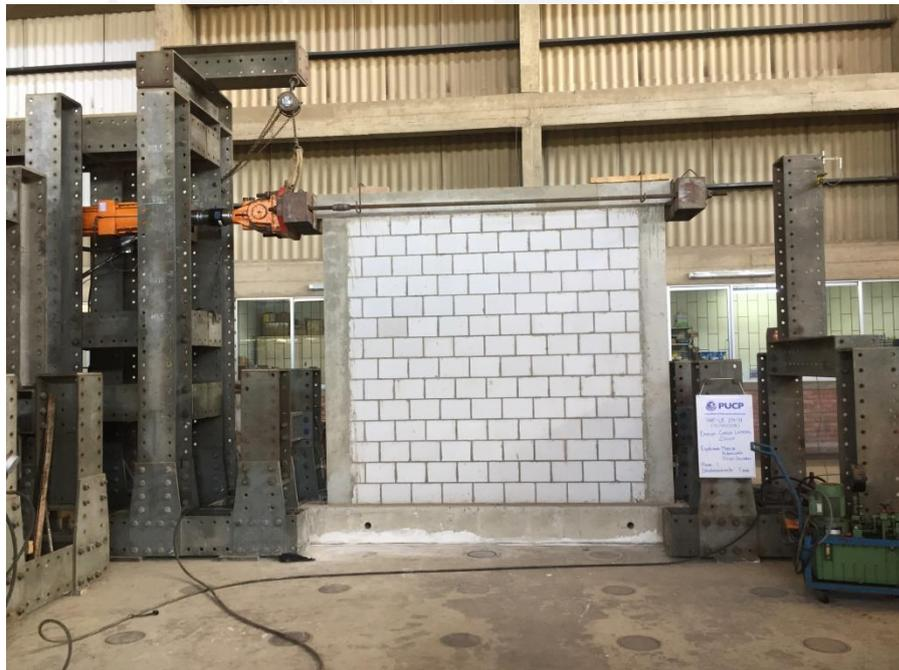
Figura 6.1. Actuador dinámico en muro
