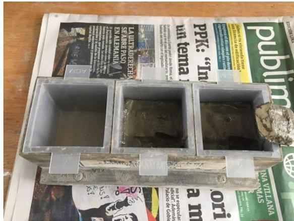
Figura 2.13 Colocación del mortero en 6 moldes metálicos
