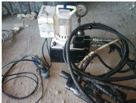
Figura 13. Equipo de tensado acoplado bomba y gato hidráulico (Fuente propia).
