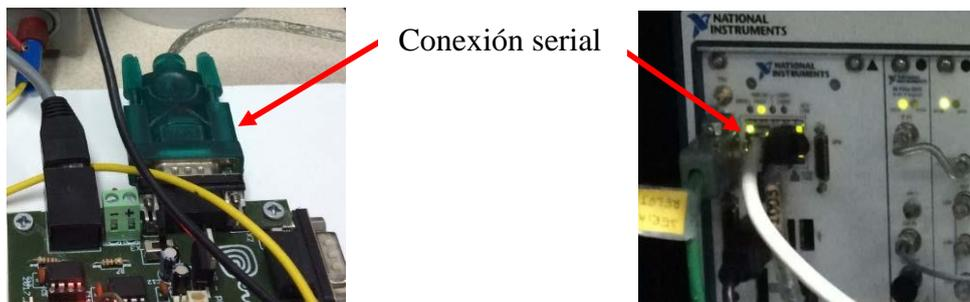
Figura 58. a) Conexión por protocolo serial de tarjeta a computador b) Conexión serial de interfaz de GPS al PXI NI.
