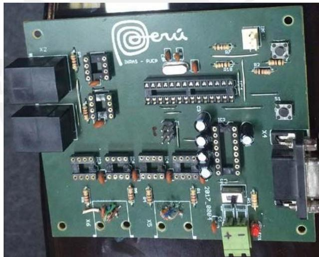
Figura 31. Tarjeta electrónica desarrollado en INRAS para control de motor de RT-8.
