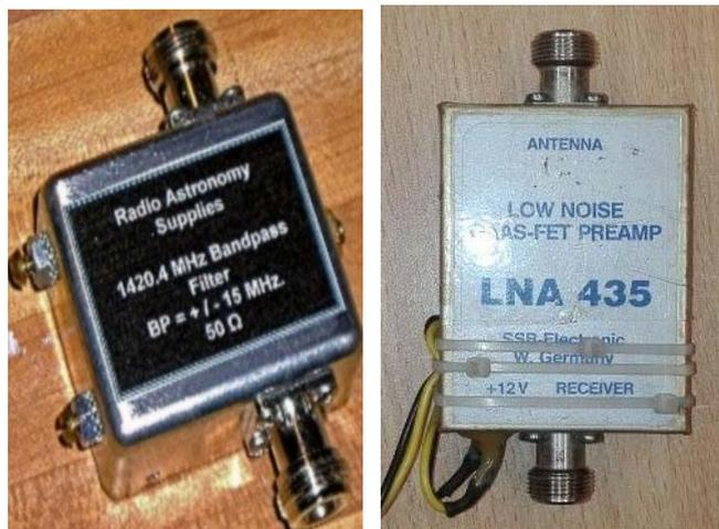
Figura 22. a) Filtro pasa banda b) LNA 435 para 1420 MHz.
