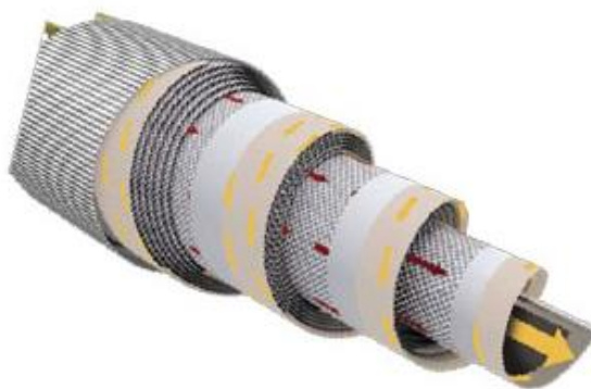
Figura 1. 15. Membrana en espiral de poliamidas 11
