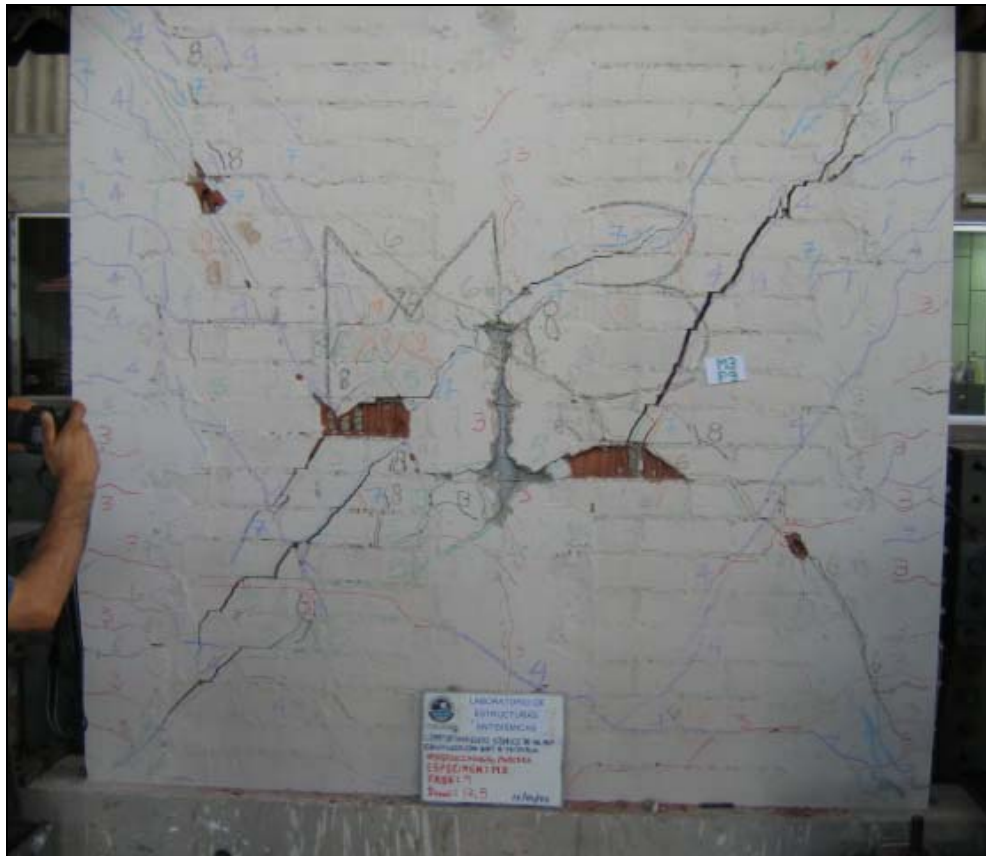
Foto 7.27. Muro M3 una vez culminada la fase 9.
