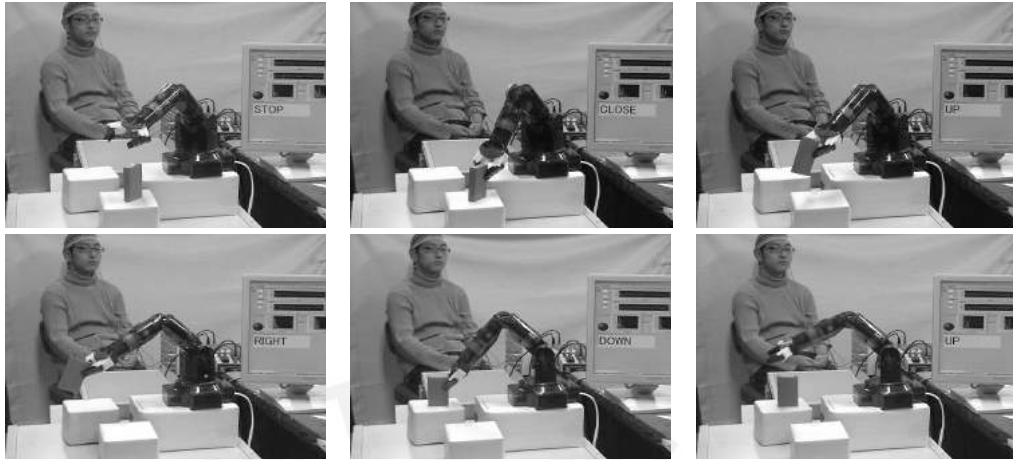
Figura 1.9: Control de robot para traslado de objetos usando ondas alfa [29].
