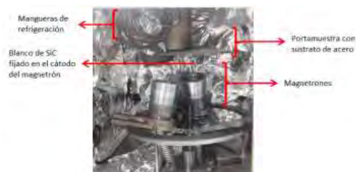
■ Figura 3.4: Cámara de vacío del equipo sputtering. Adaptado de [52]
