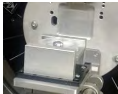
Figura 3.9: Muestra recocida a 1300 °C lista para ser analizada por DRX
