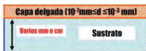
Figura 2.5: Esquema de una capa delgada recubriendo un sustrato [38]
