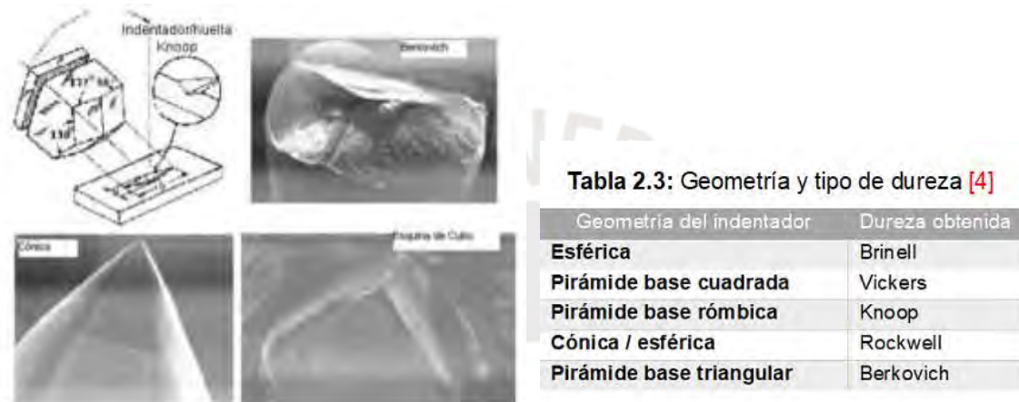
Figura 2.17: Geometrías de indentadores [63]
