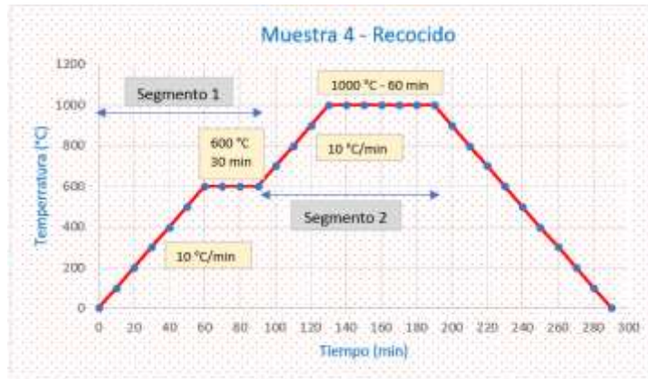
Gráfico 3.2: Calentamiento escalonado muestra recocida en atmósfera ambiental a 1000 °C
