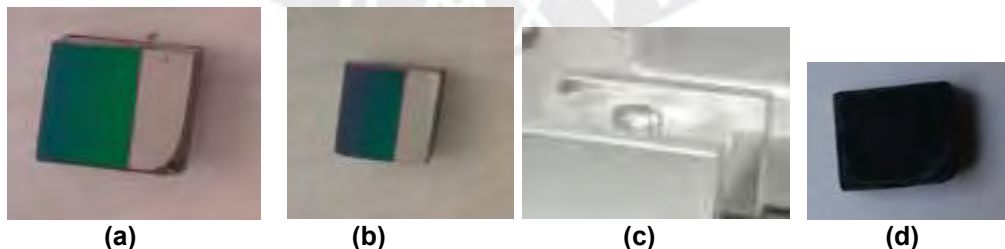
Figura 4.2: (a) Muestra 1 (recocido a 865°C por 15 min); (b) Muestra 2 (recocido a 800°C por 90 min). (c) Muestra 3 (recocido a 1300 °C por 3 horas); (d) Muestra 4 (recocido a 1000 °C por 1 hora).
