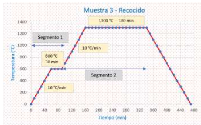
Gráfico 3.1: Calentamiento escalonado muestra recocida en atmósfera ambiental a 1300 °C
