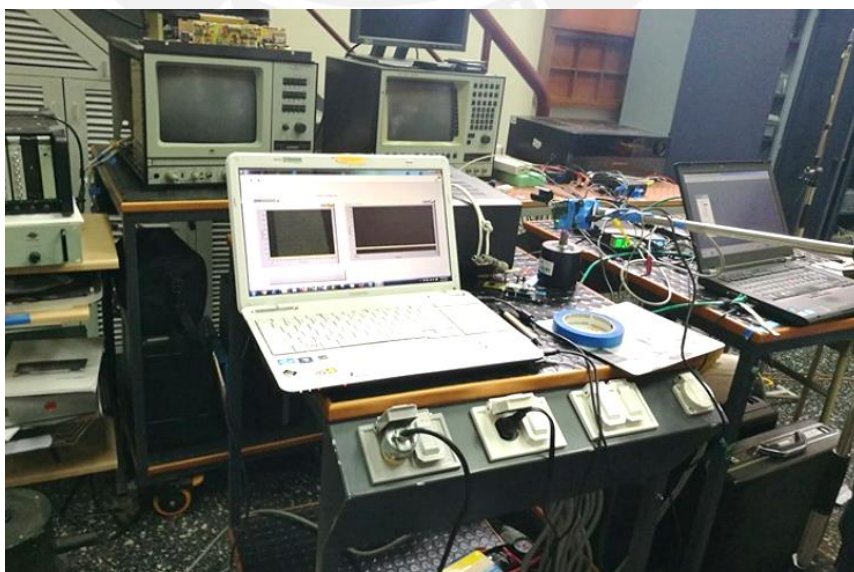
Figura 23 Realización de la prueba de comparación de la señal obtenida por sensor Hall versus señal del generador y acelerómetro.
