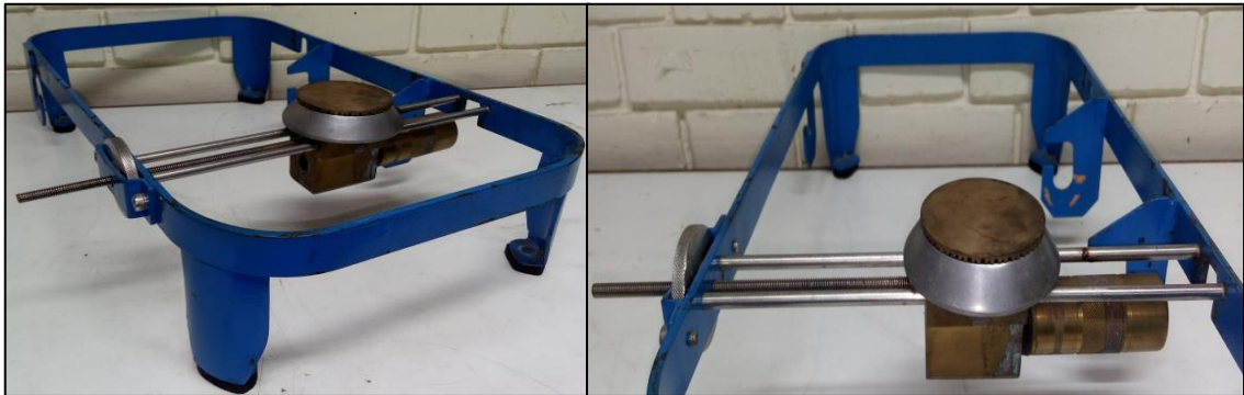
Figura 3.4. Estructura diseñada para modificar la distancia "d" entre mezclador e inyector
