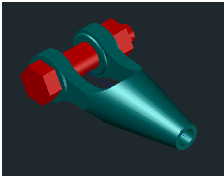
Figura 24 Modelo 3D de la mazarota de agarre de los cables
