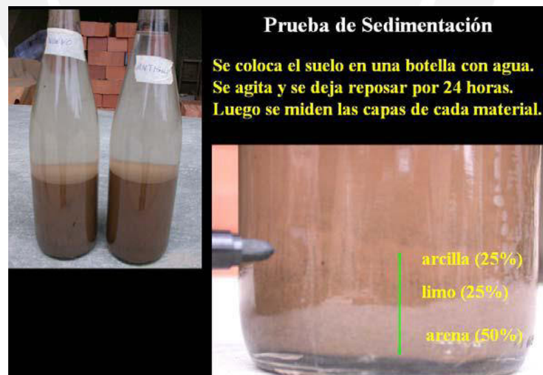
FIG. 1. Prueba de Sedimentación [SILV08]
