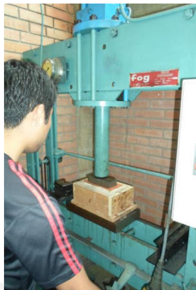
Figura 28. Ensayo de compresión
