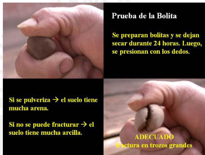
FIG. 3. Prueba de Resistencia [SILV08]
