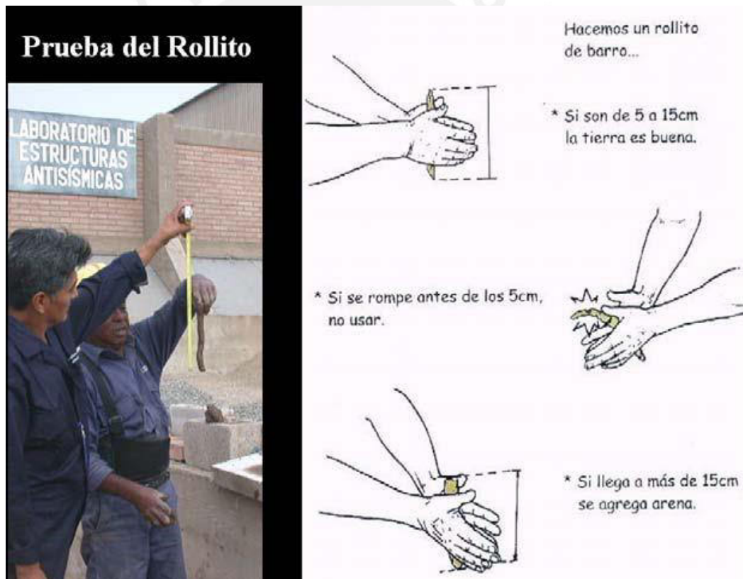
FIG. 2. Prueba de Plasticidad [SILV08]
