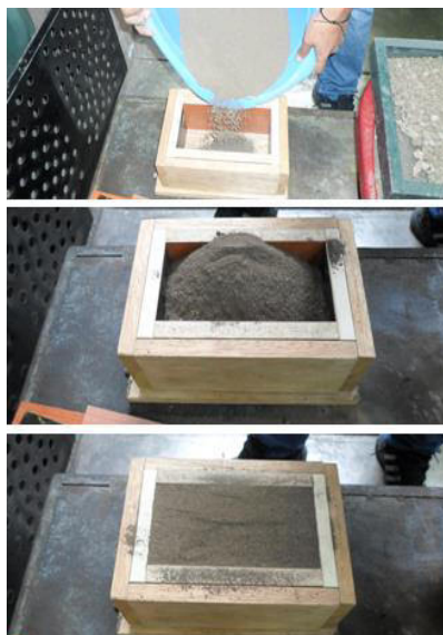
Figura 27. Alimentación del molde de ensayos
