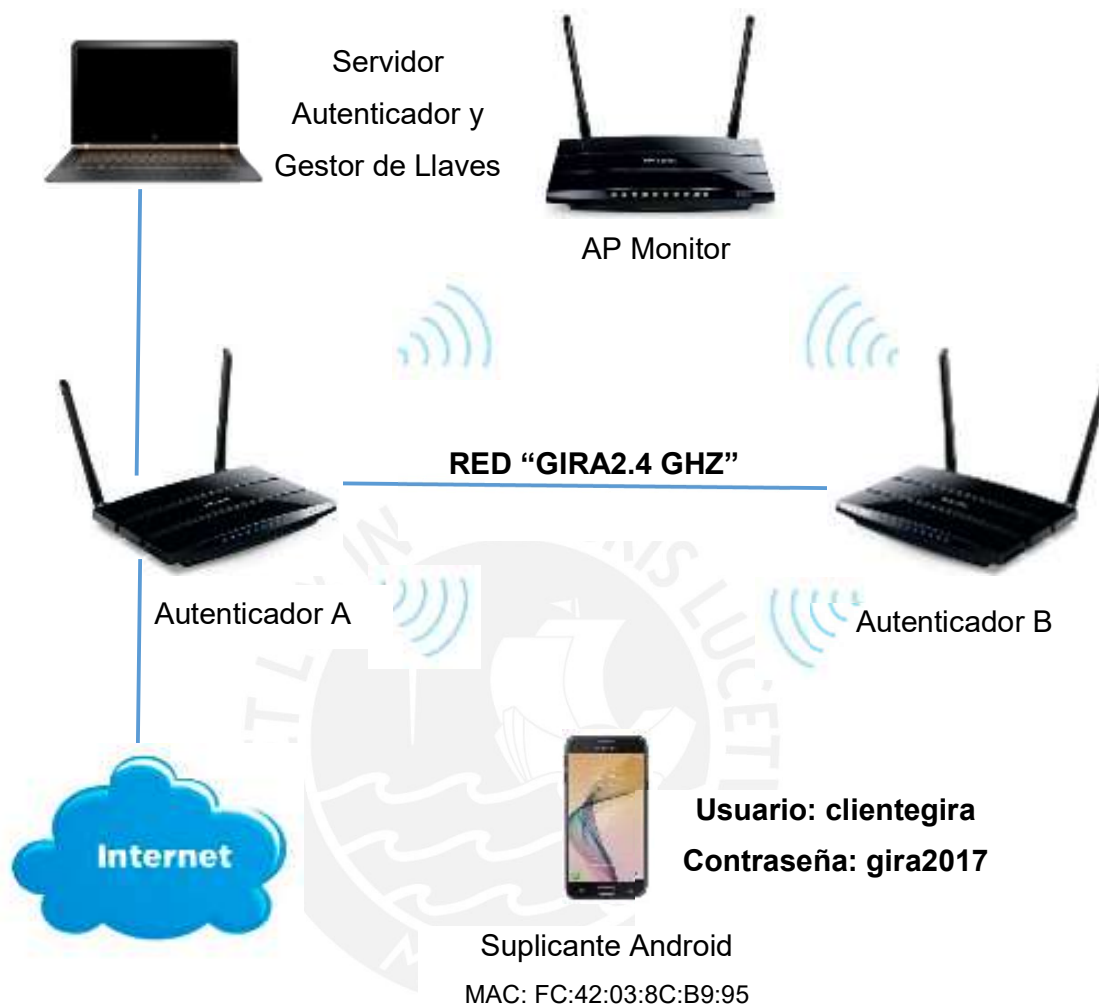
Figura 5-4 Entorno de Prueba - OpenWRT ELABORACIÓN PROPIA
