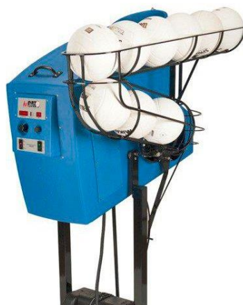
Fig. 1.11: Sistema de lanzamiento de balón usando aire. 6
