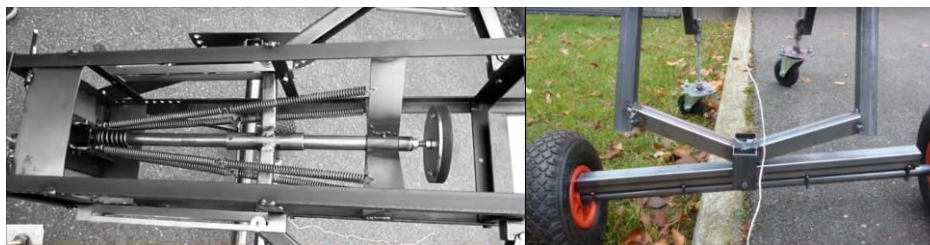
Fig. 1.12: a) Sistema de lanzamiento de balón usando resortes. b) Sistema que permite estabilidad en superficies no planas 7
