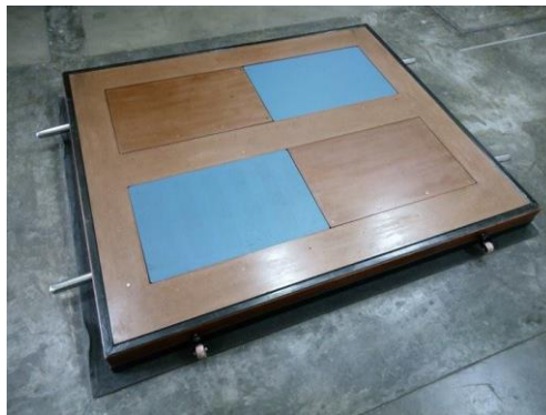
Fig. 6.2: Estructura móvil para plataformas de fuerza.
