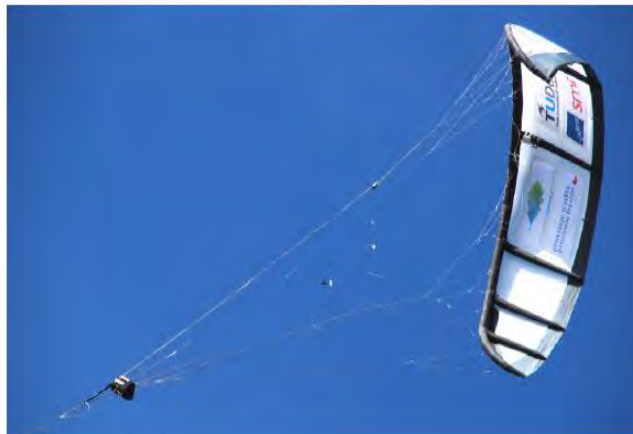
Figura 1.5: Sistema de generación tipo cometa desarrollado por Delft University of Technology Fuente: [10]
