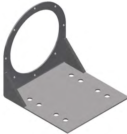
Figura 7: Soporte del generador Fuente: Propia
