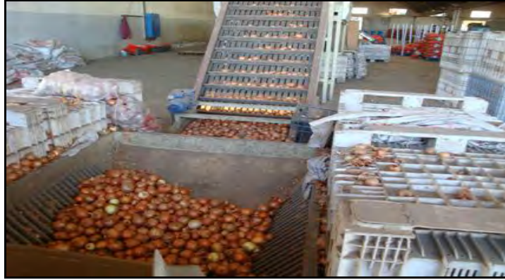
Figura 7. Línea de selección y empaque de las cebollas. Tomado de “Líneas de Packing y Equipamiento para el Proceso de Ajos y Cebollas,” por Albion, 2011. Recuperado de http://www.armstrongchile.cl/products/view/209 .
