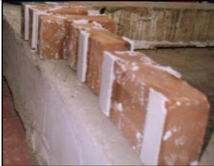
Figura N° 3.7. Aplicación de capping de yeso a la unidad.
