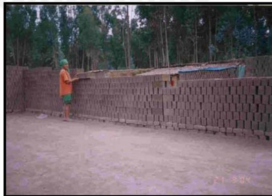
**Figura N° 2.13.** Colocado de los ladrillos en pircas para el secado.
