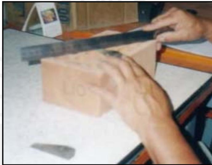
Figura N° 3.3. Ensayo de alabeo en una unidad de la ciudad de Cajas.
