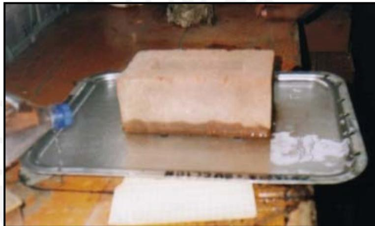
Figura N° 3.13. Evaluación de la succión en una unidad de ladrillo de Palian-Huancayo.
