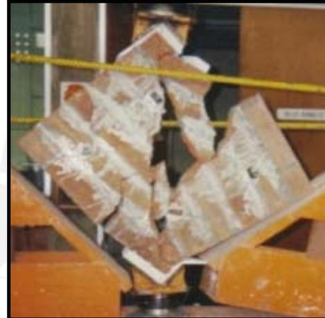
**Figura N° 3.22.** Muretes ensayados de Cajas.
