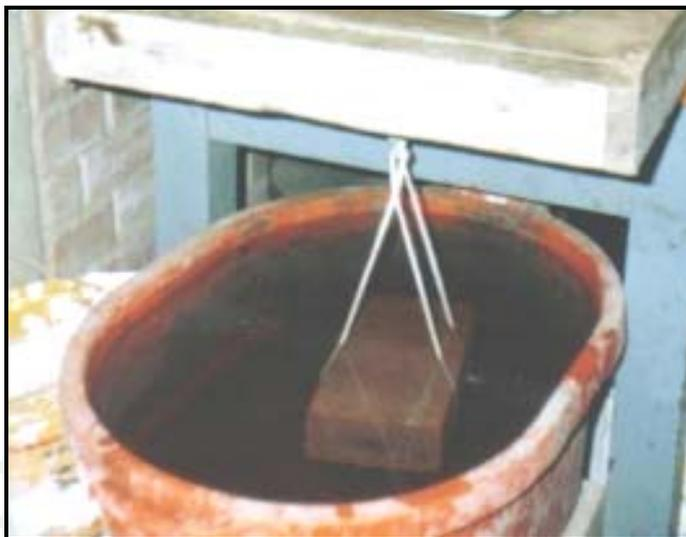
**Figura N° 3.9.** Control de peso de unidad sumergida.
