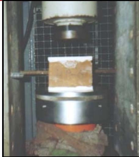
**Figura N° 3.6.** Medias unidades con su capping de yeso en la máquina de ensayos.
