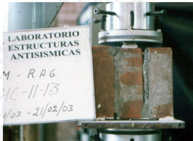
Figura Nº 3.42 Especímenes en máquina de ensayos, antes de aplicar la fuerza.
