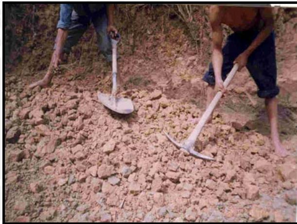
**Figura N° 2.2.** Desterronado y separado de impurezas.
