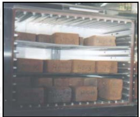
**Figura N° 3.14.** Medias Unidades saturadas. **Figura N° 3.15.** Medias Unidades secadas al horno
