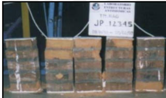
**Figura N° 3.20.** Prismas ensayados de Jauja
