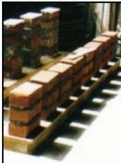
Figura N° 3.40 Especímenes para el ensayo de adhesión por flexión
