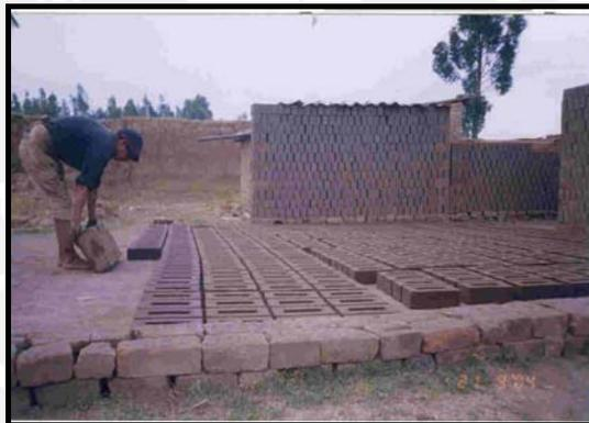
**Figura N° 2.11.** Depósito de las unidades, en tendal previamente nivelado
