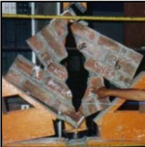
**Figura N° 3.23.** Muretes ensayados de Saño.
