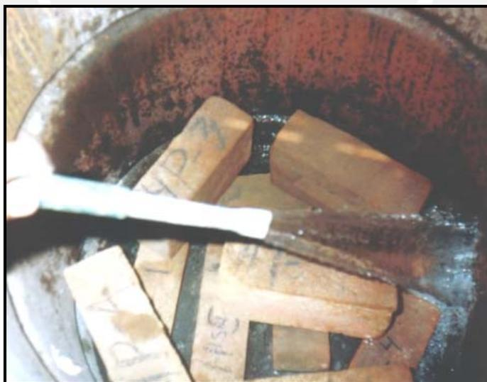
**Figura N° 3.10.** Nótese la colocación de unidades y suministro de agua.
