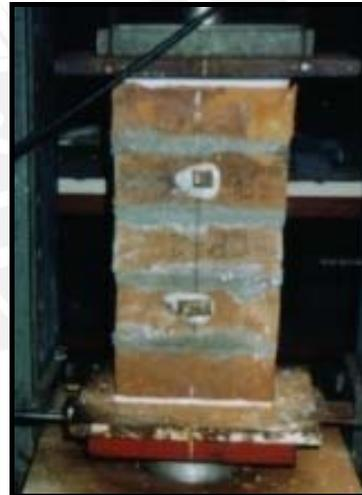
**Figura N° 3.17.** Prisma ensayado de Cajas.
