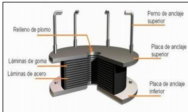
Imagen 2. Aislador sísmico elastomérico y su estructura
