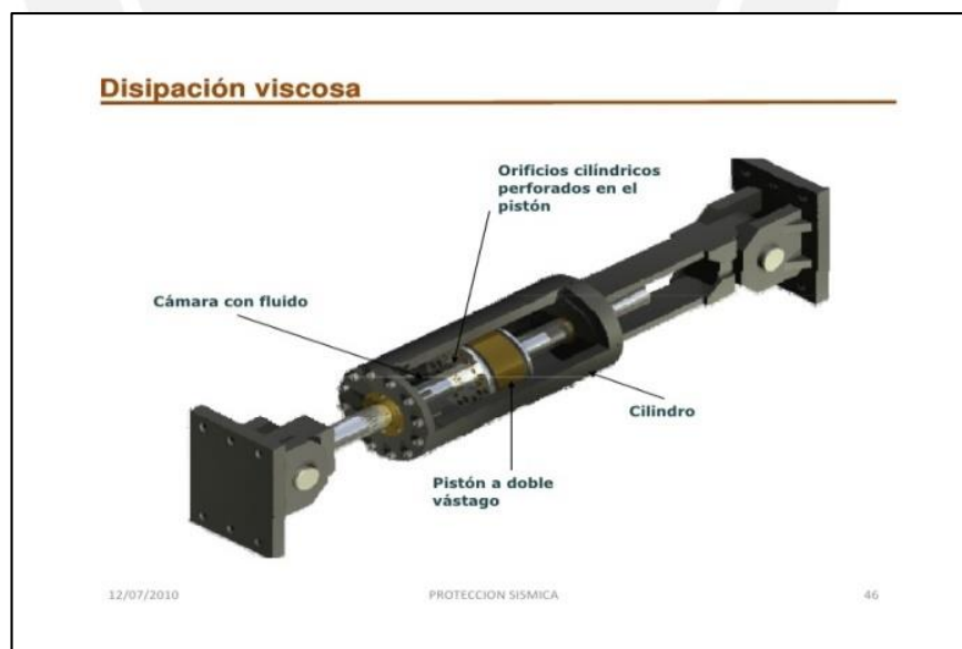
Imagen 1. Disipador Sísmico Viscoso y su estructura
