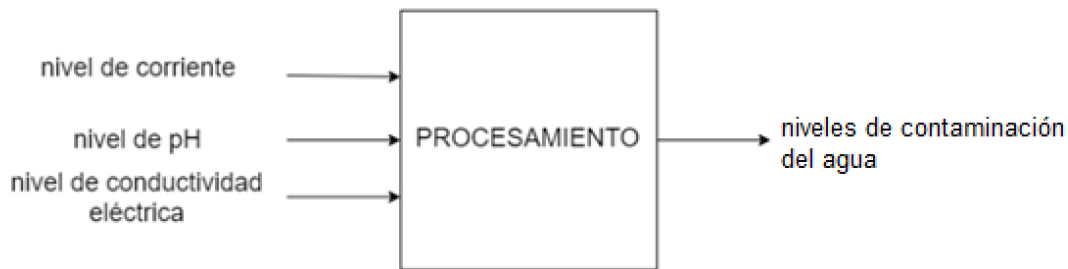
Figura 4.1.1: Diagrama de variables sensadas y su salida para medir contaminación por mercurio (Fuente: Elaboración Propia)
