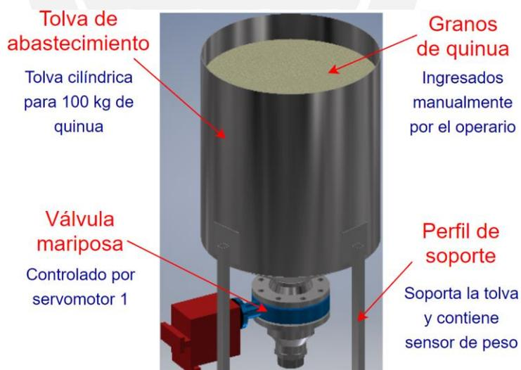
Figura 3- 12. Subsistema de carga. Fuente: Elaboración propia.
