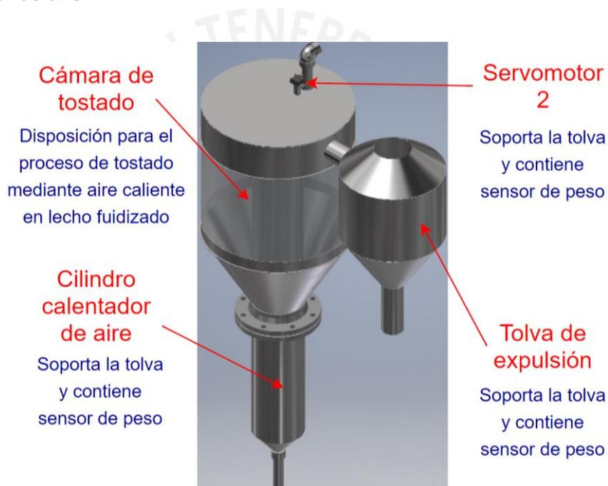
Figura 3- 17. Subsistema de tostado. Fuente: Elaboración propia.
