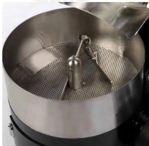
Figura 1- 16. Enfriador por movimiento de granos y succión de aire.
