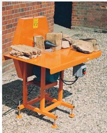
Figura 1. 13. Astilladora de tornillo (Fuente: Hydrocut)
