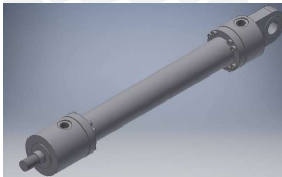
Figura 3. 38. Cilindro hidráulico \phi 63 x \phi 40 x 550
