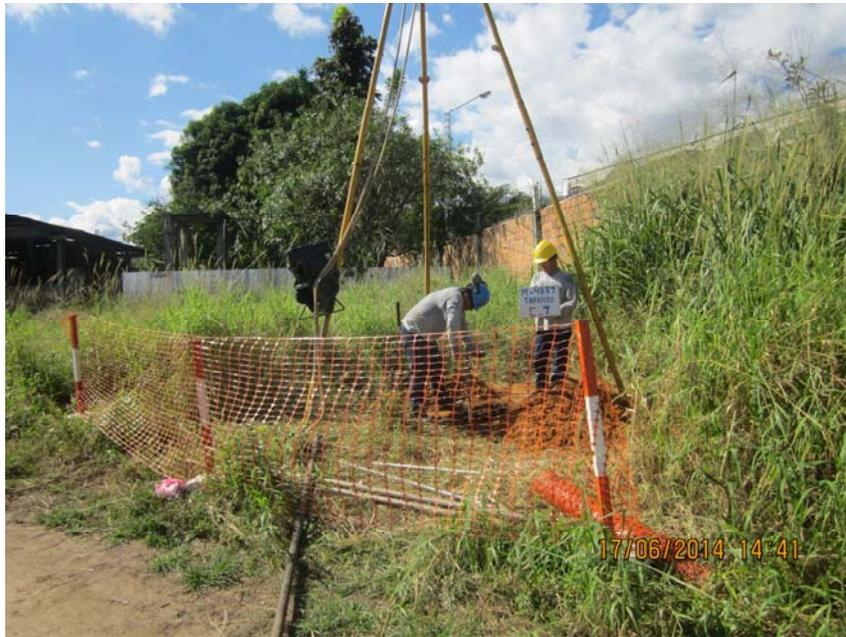
PROFUNDIZACIÓN DE LA CALICATA C-7 CON PERFORACIÓN CON IWAN AUGER.
