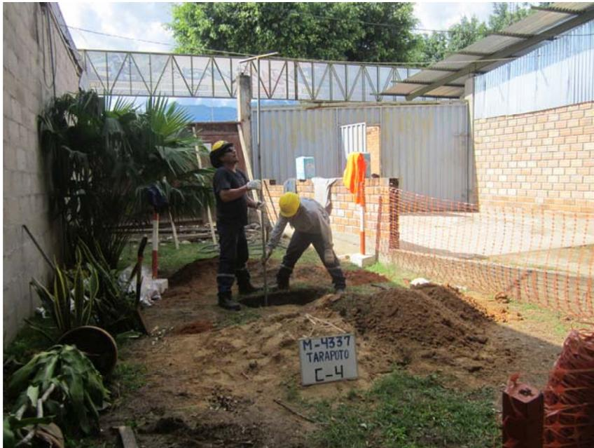
UBICACIÓN DE LA CALICATA C-4. SE APRECIA EL EQUIPO DE PERFORACIÓN IWAN AUGER UTILIZADO PARA PROFUNDIZAR LA CALICATA.
