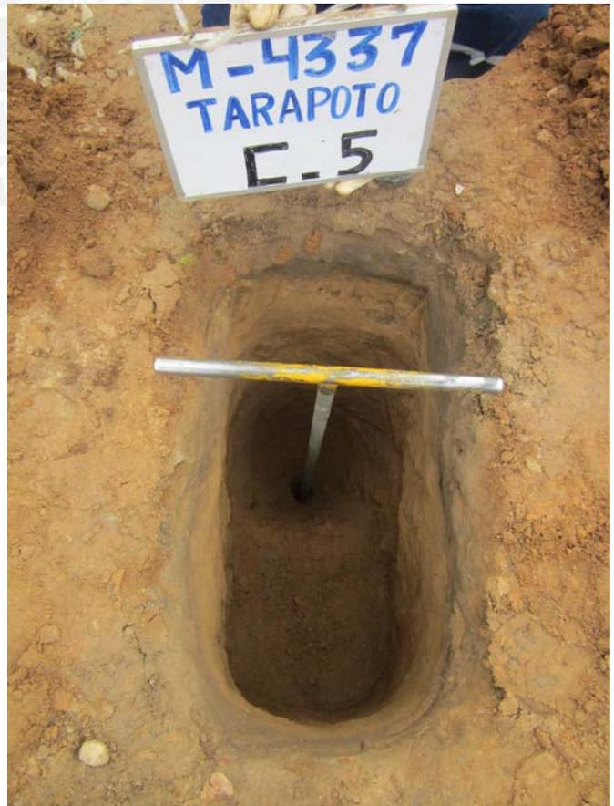
VISTA HACIA EL INTERIOR DE LA CALICATA C-5. SE APRECIA EL EQUIPO DE PERFORACIÓN IWAN AUGER UTILIZADO PARA PROFUNDIZAR LA CALICATA.
