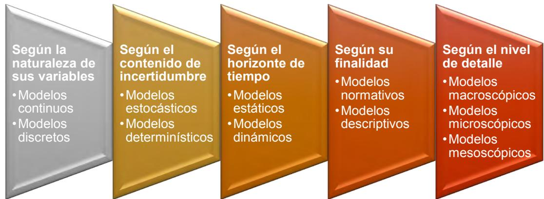
Figura 1. Tipos de modelos del tráfico
