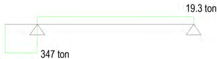
Figura 9.11 Diagrama de fuerzas cortantes en viga de cimentación VC-03 (Ton)
