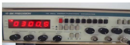
Figura 4.23 Generador a frecuencia de 300 KHz.
