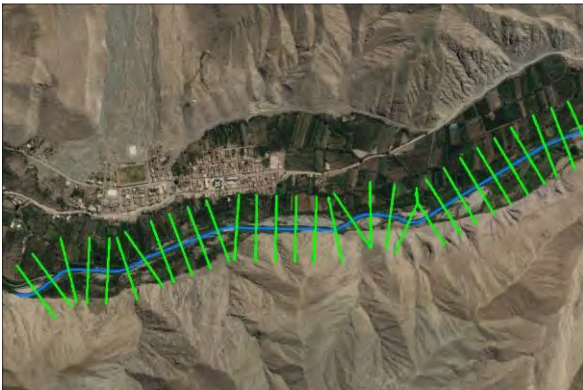
Figura 33. Secciones transversales cada 75m del río Mala digitalizadas con la extensión Hec-GeoRas
