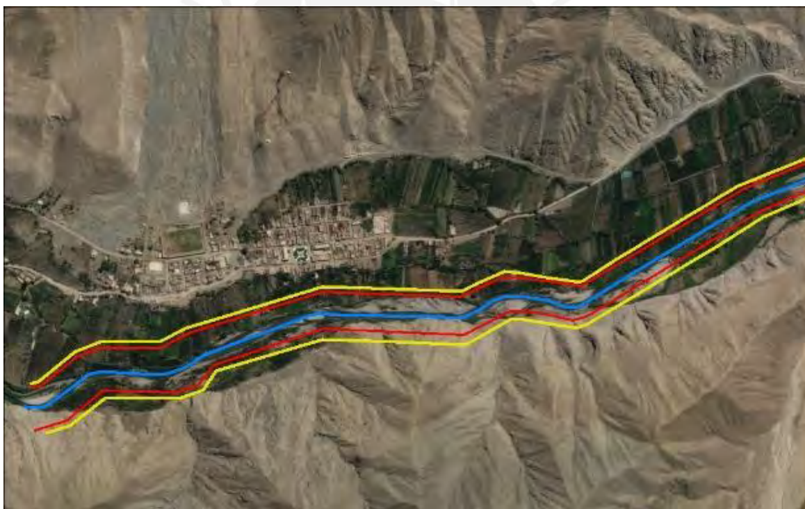
Figura 32. Digitalización geométrica de un tramo del río Mala mediante la extensión Hec-GeoRas
