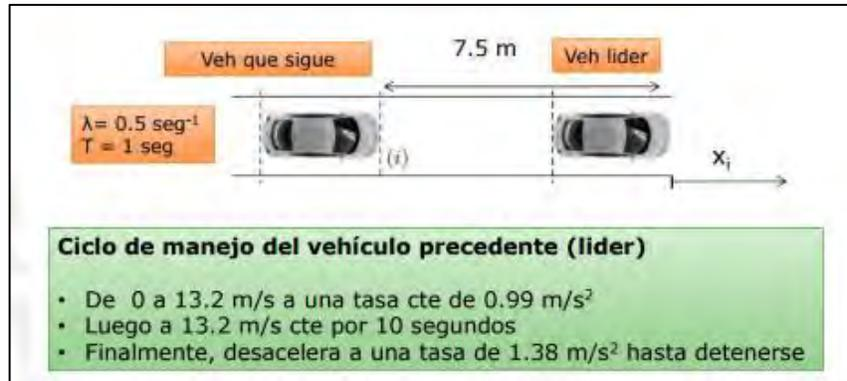
Figura 7. Seguimiento vehicular representado por un modelo de General Motors
