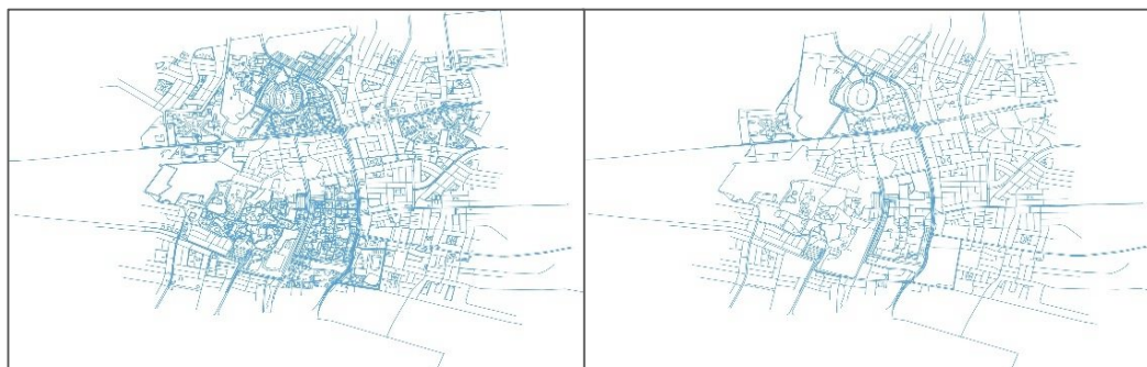
Figura 17: Ejemplo antes y después de la limpieza del grafo
