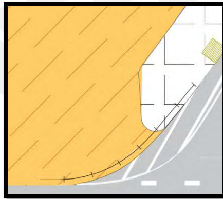
Figura 4.4 Colocación de las barandas en el primer punto
