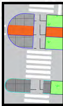
Figura 4.19 Corte en la mediana y en la isla refugio ubicado en la Av. Metropolitana
