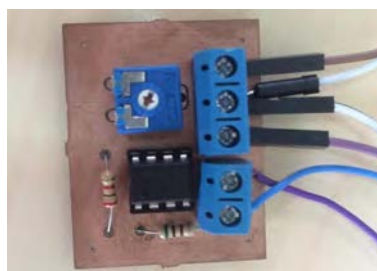
Figura 4.10 Tarjeta OPAM implementada.
