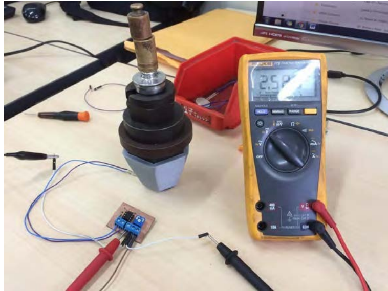
Figura 4.12 Lectura de voltaje en salida tarjeta Opam. La estructura en impresión 3D con las pesas empleadas en el ensayo.
