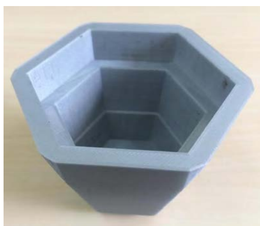
Figura 4.11 Estructura en impresión 3D para la colocación de pesas.
