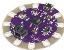
Figura 3.12 Arduino LilyPad USB 17
