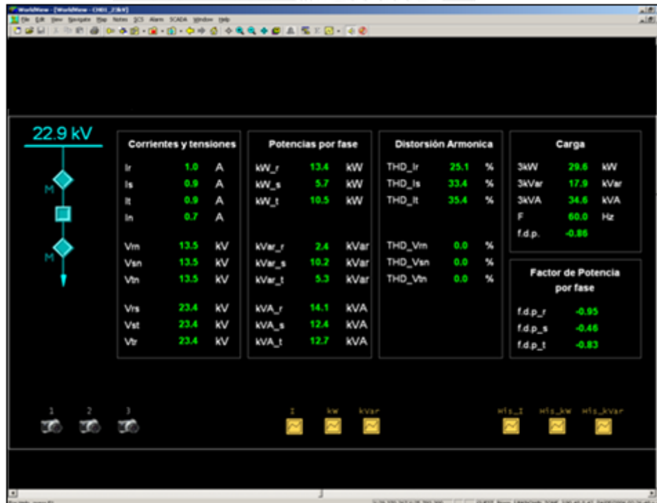
Figura 3.19 - Interfaz Gráfica del Sistema SCADA. (Elaboración Propia)
