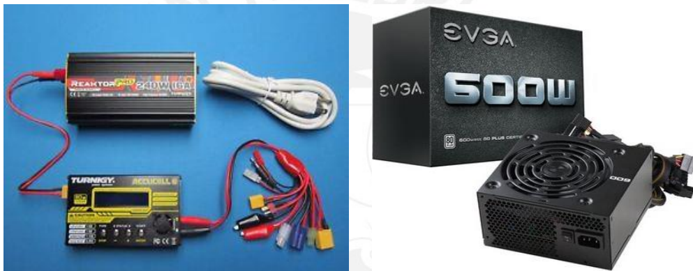
Figura 3.14 a) Módulo cargador de Batería LiPo DBT Figura 3.14 b) Fuente de Poder de 12V y 600 W.
