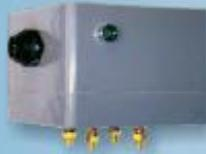
➤ Indicador de campo del correcto funcionamiento del sensor, ubicado en el transmisor.
