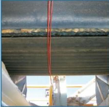
En el año 2010, en una mina del Perú, se produjo el corte de 1100 metros de correa por partes del sistema de limpieza de la correa que cayeron sobre el lado retorno y fueron aprisionados contra la polea motriz, en una faja transportadora de chancado primario de 3 Km de largo, debido a una mala ubicación de los sensores del sistema de detección de rotura de correa. Los costos fueron de 750 mil dólares y 4 días de parada.
