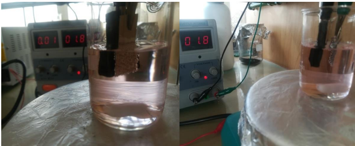
Figura 20. Electrodeposición de óxidos mixtos de manganeso-cobalto.
