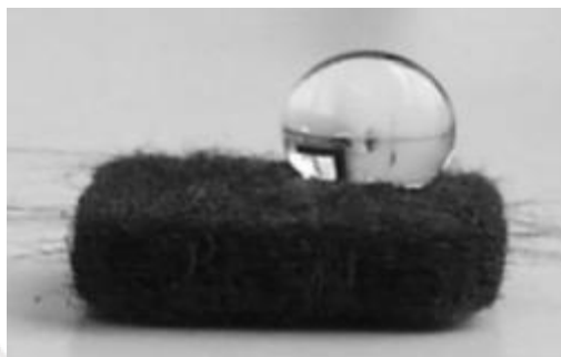
Figura 9. Imagen de una gota de agua sobre fieltro de grafito, tomada 30 s después de que la gota de agua fuera depositada en la superficie del fieltro 17 .
