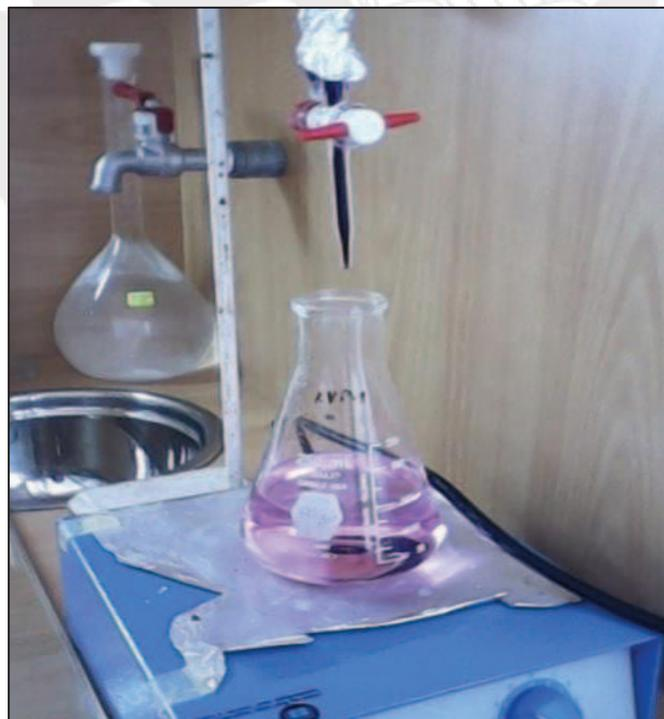
Figura 8. Titulación con  $KMnO_4$  para determinar la cantidad de  $H_2O_2$
