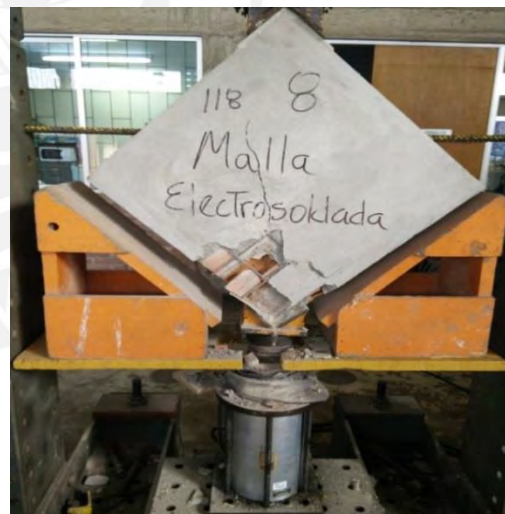
Figura N° 43: Falla por tracción diagonal de murete N° 7 (Tipo M3)
