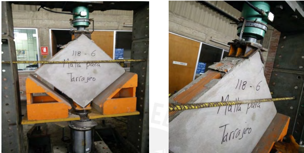
Figura N° 41: Falla local de murete N° 6 (Tipo M2)
