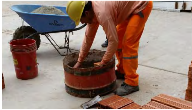
Figura N° 12: Toma de muestra de mortero
