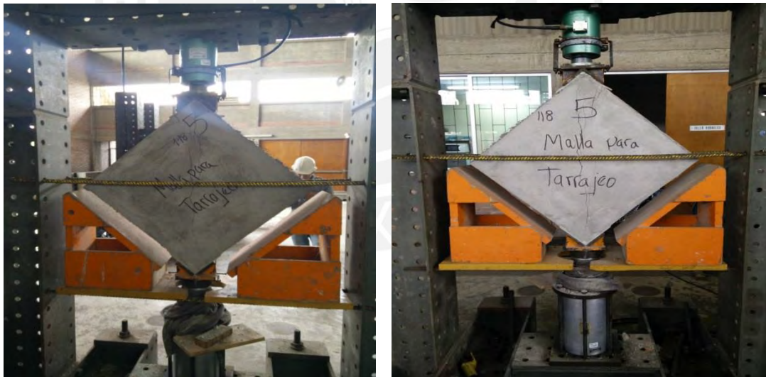
Figura N° 40: Falla por tracción diagonal de murete N° 5 (Tipo M2)
