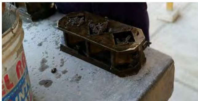
Figura N° 14: Llenado de mortero en celdas metálicas
