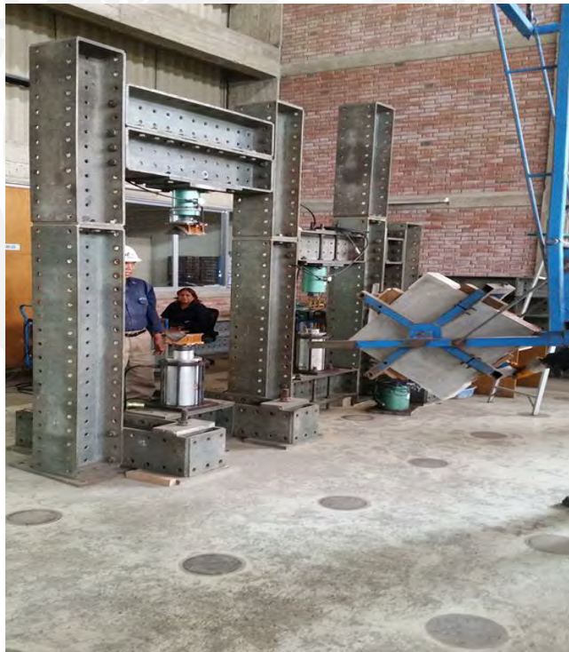
Figura N° 34: Izaje de muretes para ensayos a compresión diagonal
