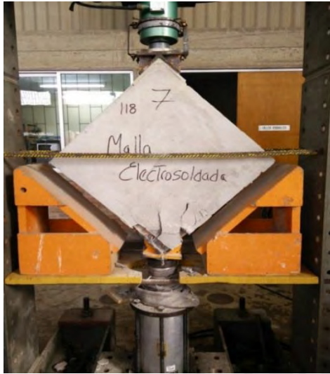
Figura N° 42: Falla local de murete N° 7 (Tipo M3)
