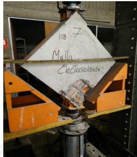
Figura N° 42: Falla local de murete N° 7 (Tipo M3)
