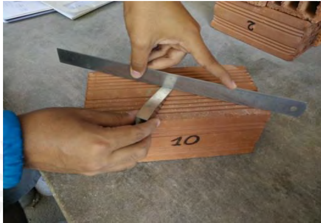
Figura N° 8: Ensayo de alabeo
