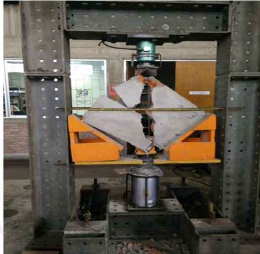
Figura N° 38: Falla por tracción diagonal en murete N° 3 (Tipo M1)
