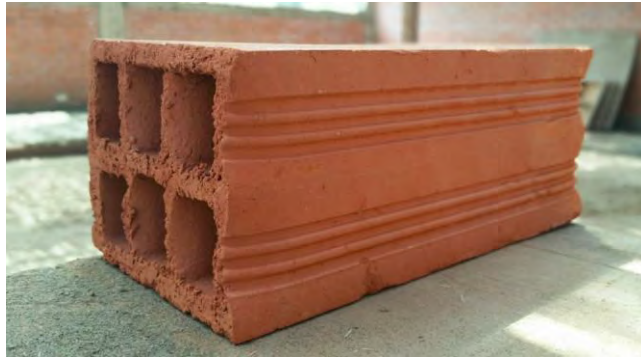
Figura N° 2: Ladrillo pandereta - Pirámide
