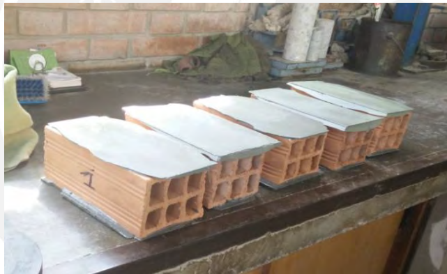
Figura N° 9: Refrentado de ladrillos
