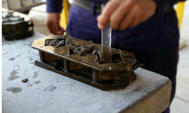
Figura N° 15: Apisonado de primera capa de mortero
