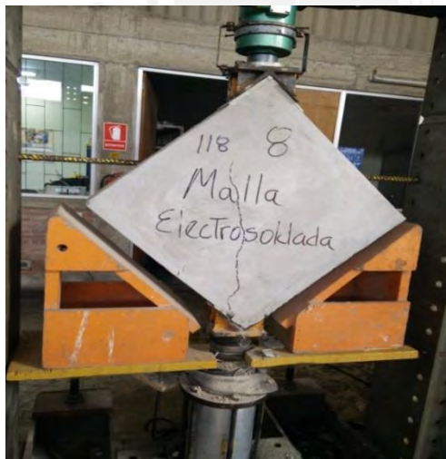
Figura N° 43: Falla por tracción diagonal de murete N° 7 (Tipo M3)
