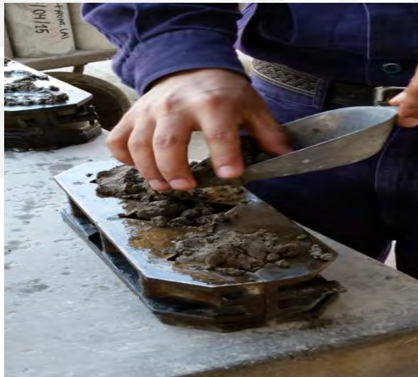
Figura N° 16: Apisonado de segunda capa de mortero
