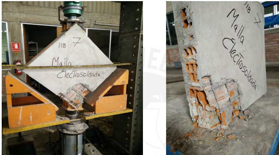
Figura N° 48: Autopsia de murete N° 7
