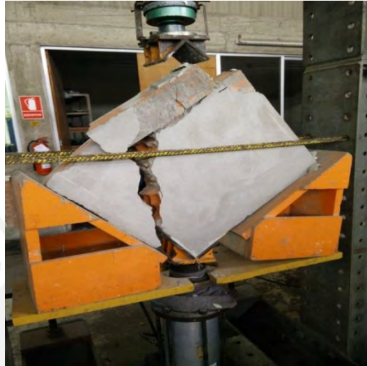
Figura N° 36: Falla mixta de murete N° 1 (Tipo M1)
