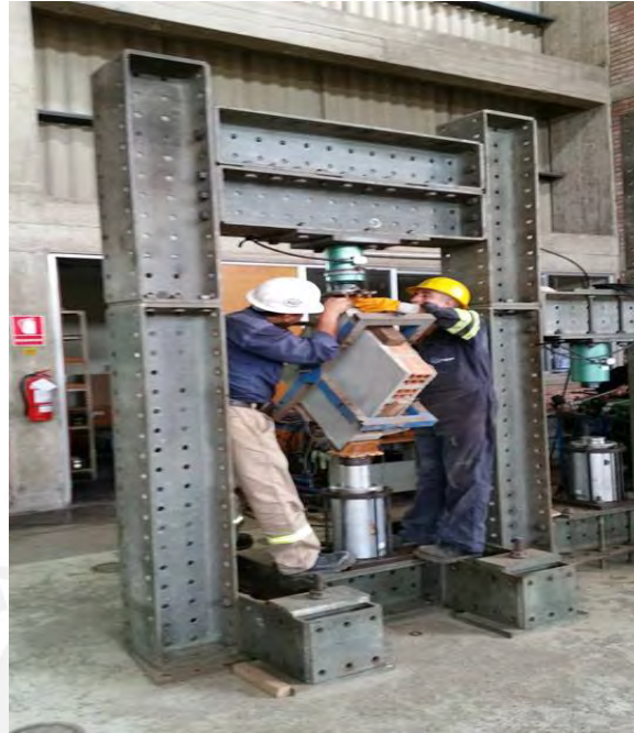
Figura N° 35: Centrado de cabezales para ensayo a compresión diagonal
