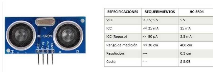
Figura 4.4. Especificaciones del módulo HC-SR04. [Elaboración Propia]
