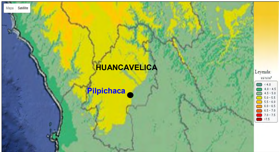
Figura 3.2 - Nivel de Irradiación Solar en el mes de Junio (Fuente: Atlas Solar del Perú – SENAMHI, 2003).
