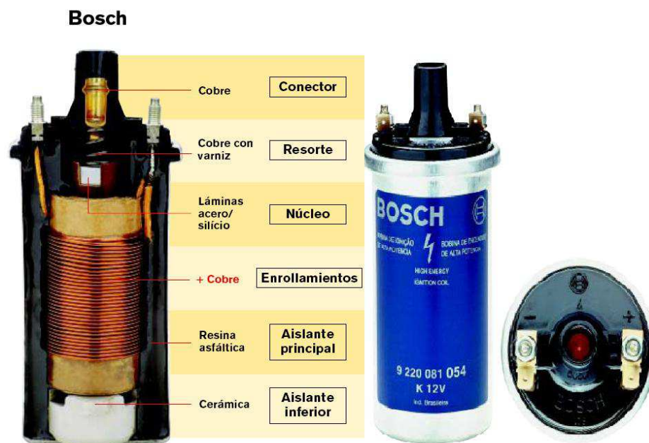
Figura 6.1 Componentes internos de la bobina de encendido Bosch. <Catalogo Bosch>
