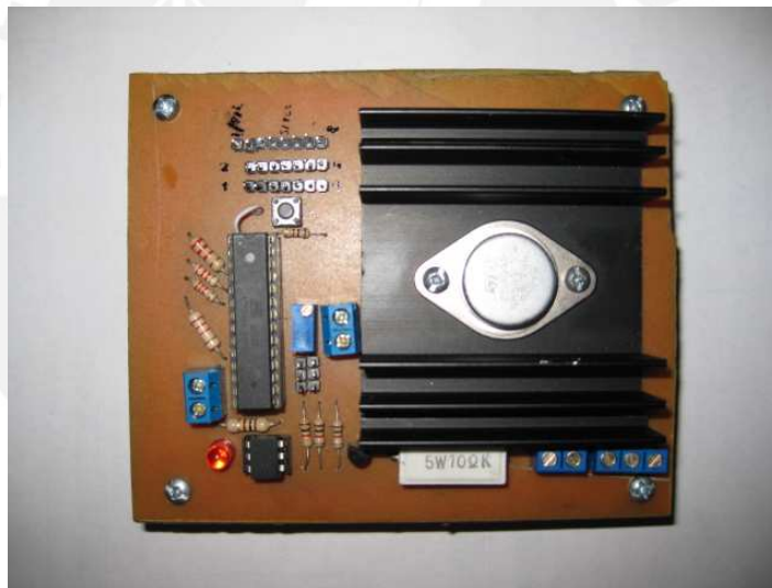
Figura 6.8 Implementación de tarjeta de control y potencia
