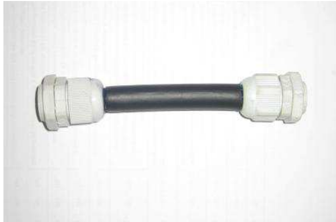
Figura 6.4. Manguerilla implementada para simulación de transporte de ozono
