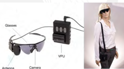
Figura 2.1: Componente Interno del sistema de prótesis de retina Argus II [16].
