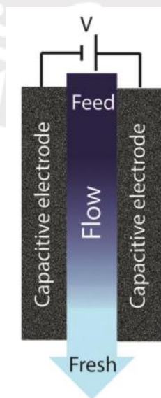
Figura 8. Diagrama general del diseño de flujo entre electrodos (15).
