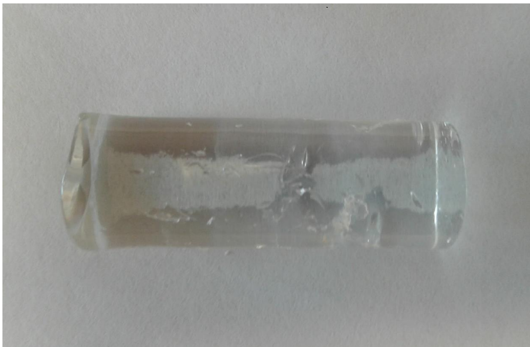
Figura 64. Hidrogel IPN y el hidrogel compuesto por macromonómero de 2-oxazolina y acrilamida después de la hidrólisis.
