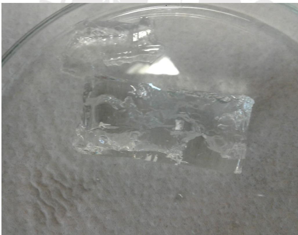
Figura 65. Hidrogel basado en macromonómero 2-oxazolina y acrilamida, luego de la separación del hidrogel IPN.
