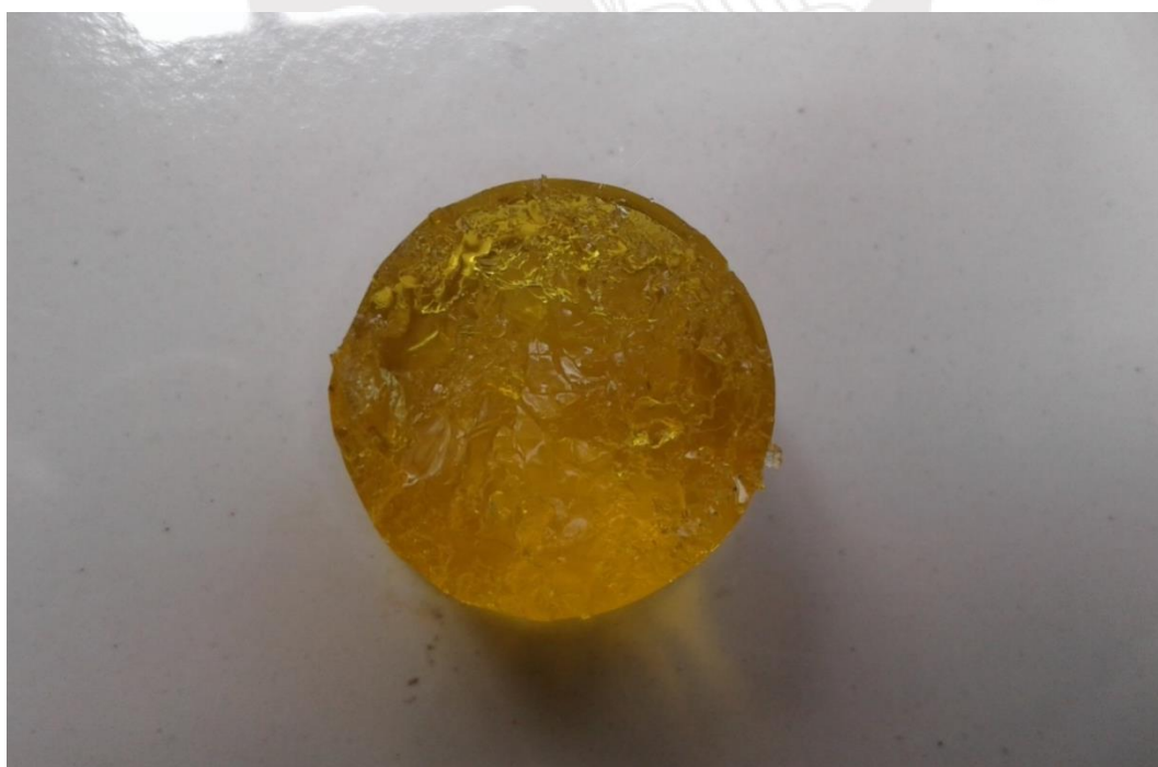
Figura 63. Hidrogel IPN y de 2-oxazolina antes de hidrolizar.
