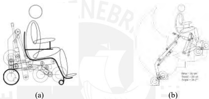
Figura 1.11: Silla de ruedas de [Lawn,2003] – (a) Plegada y (b) desplegada en ascenso
