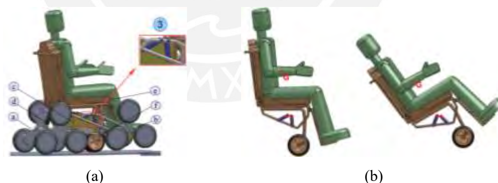
Figura 1.10: Silla de ruedas de [Quaglia,2009] – a) Elementos que conforman el sistema mecánico, y b) Asiento pivotante del pasajero
