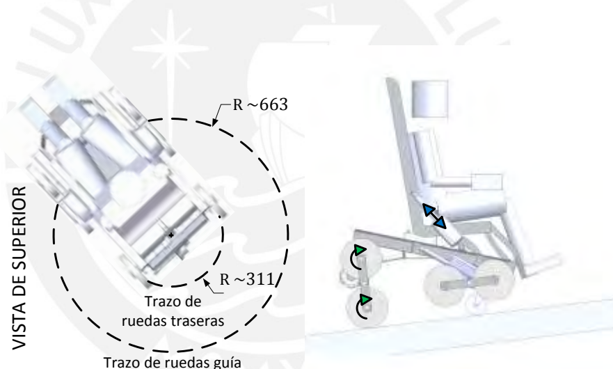
Figura 2.16: Estado C. Giro diferencial y ascenso sobre rampa de 12%
