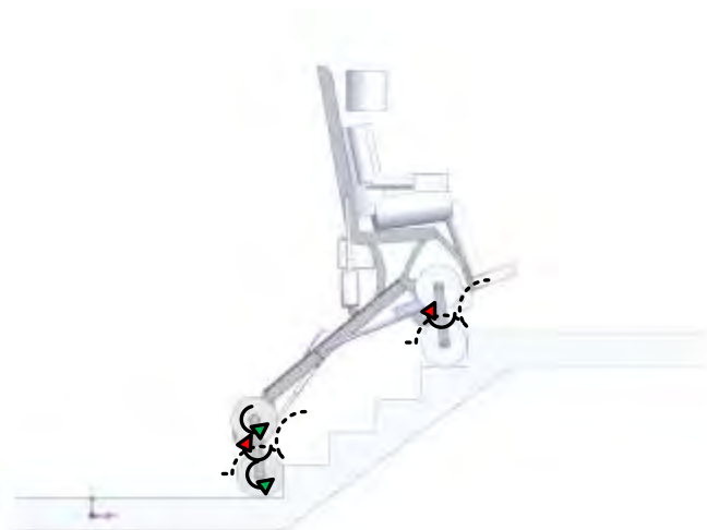
Figura 2.23: Estado I. Ascenso coordinado de clústeres a pendiente máxima. Giros en Clúster delantero + Clúster trasero + Ruedas traseras
