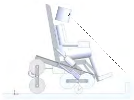
Figura 2.17: Estado D. Detección y confirmación del primer escalón.
