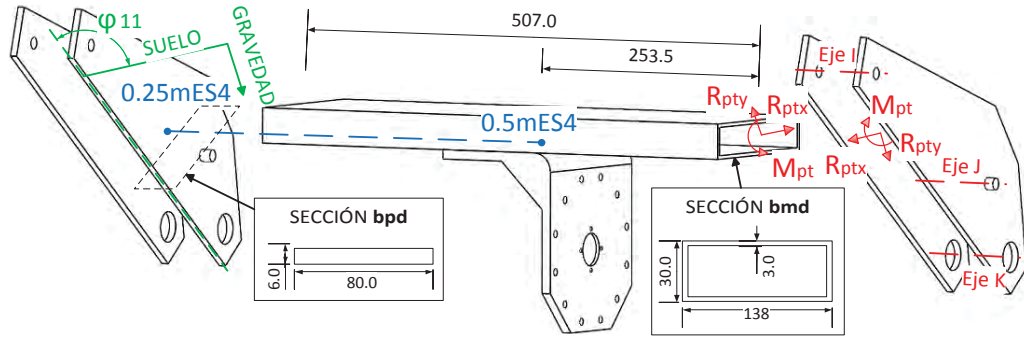
Figura G.22- Reacciones internas de la estructura soporte 4 “Patas Delanteras” descompuestas hacia los ejes SUELO(x) y GRAVEDAD(y); y consideraciones auxiliares en la obtención de los diagramas de fuerza y momento. Las cotas sobre la barra motor delantero (bmd) indican longitudes medias de separación entre estas reacciones y las no mostradas consideradas sobre un solo plano: m_{sMCDg} , m_{MCDg} , R_{MCD} , M_{MCD} , y 0.5m_{ES4g} .
