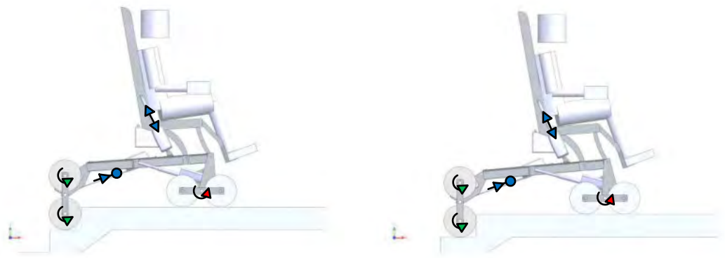
J10. Transición (flechas) de J9 a J10: giros en RT+CD, retracción de ALT y regulación de ALS
