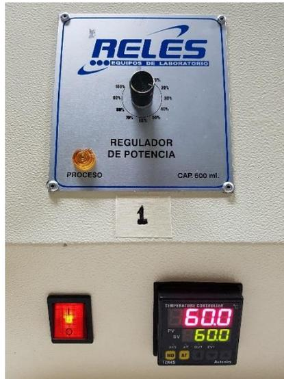
**Figura 5.** Sistema termostático estabilizado a 60°C
