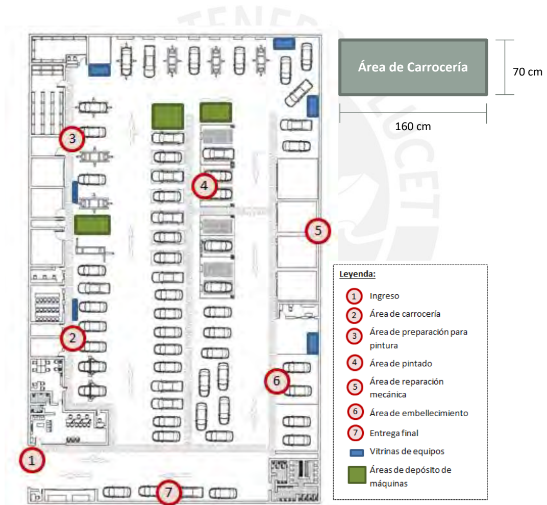
Figura 4.13. Layout - Áreas a ejecutar trabajos Elaboración propia
