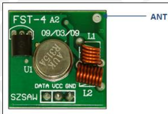
FIGURA 3.12: Módulo transmisor FST-4 [22]
